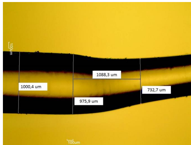
Figura 4.4: Ampliação da deformação causada no processo de afinamento da fibra com casca de 1 mm, visualizada pelo microscópio.
