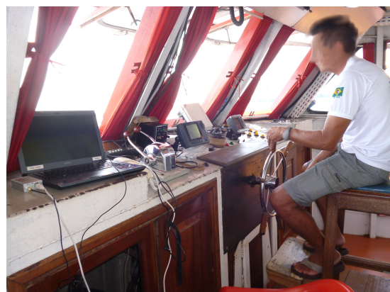
(b) GPS u-blox ligado ao laptop na cabine do comandante do barco.
