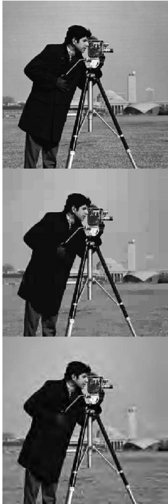
Figura 4.17: Cameraman codificada. Imagem original (esquerda), GSM-MMP a 0,30 bpp com PSNR = 29,95 dB (centro) e JPEG2000 a 0,30 bpp com PSNR = 28,30 dB (direita).
