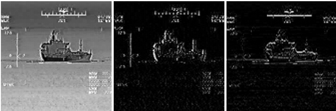
Figure 14: Gradiente direcional. Da esquerda para a direita: imagem original, gradiente horizontal (com um elemento estruturante horizontal) e gradiente vertical (com um elemento estruturante vertical).
