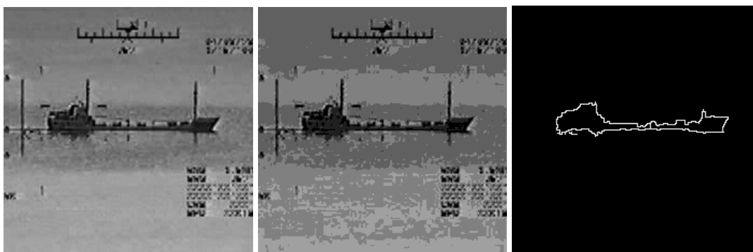
Figura 38: Teste da limiarização em oito níveis como simplificação para a imagem que será submetida à transformação watershed. Da esquerda para direita: imagem original, imagem limiarizada em oito níveis e resultado da transformação watershed.
