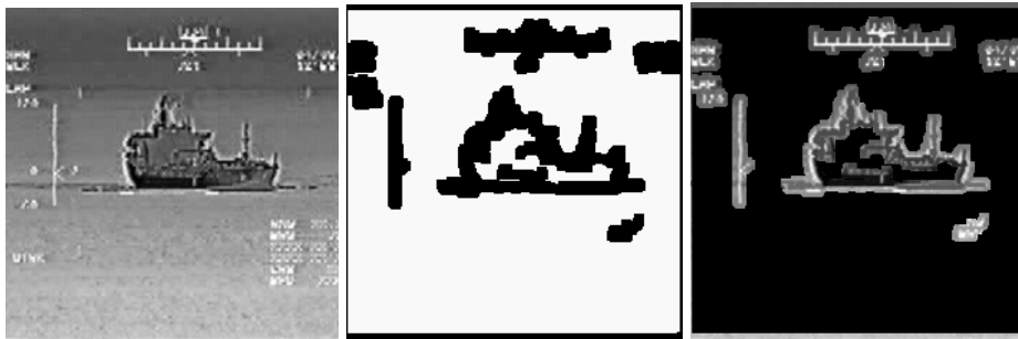
Figura 30: Imposição de mínimo. Da esquerda para a direita imagem de entrada, imagem marcadora e imposição de mínimo.
