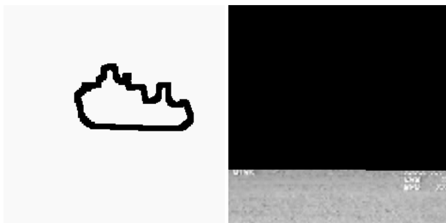
Figura 37: Elemento estruturante escolhido para dilatar o conjunto de bordas escolhidas. Marcador realizado a partir da dilatação das bordas escolhidas manualmente, a partir da dilatação por um elemento estruturante quadrado de 6X6 pixels (esquerda) e watersheds extraídas sobreposta a imagem original (direita)
