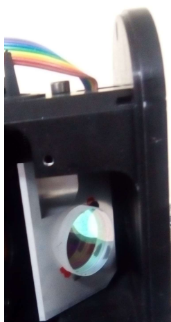
Figura C.2: Disposição do cristal 2\omega do laser Nd:YAG.
