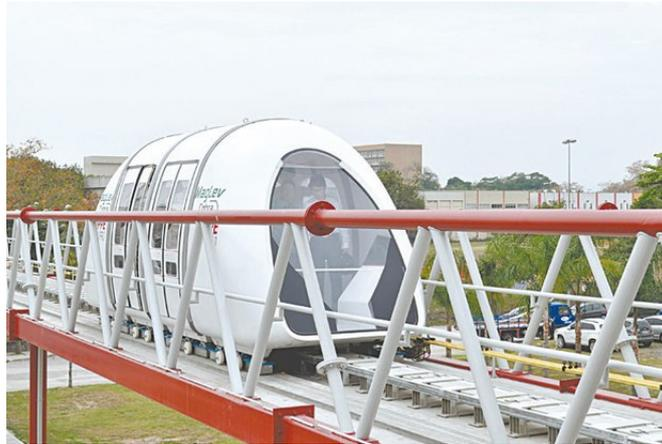
Figura 2.5: Trem maglev cobra desenvolvido no lasup.
