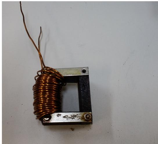
Figura 3.13: Núcleo ferromagnético com enrolamento primário de cobre utilizado para indução de campo magnético no interior do laço supercondutor.
