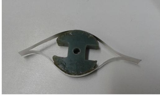
Figura 2.16: Espira com fita parcialmente cortada.
