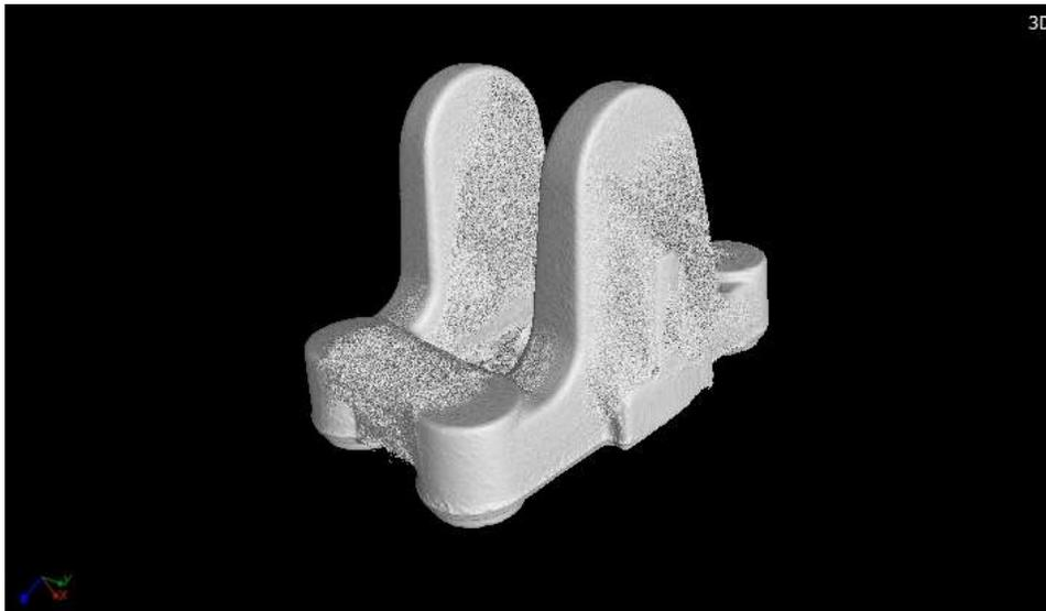
Figura 89 – Volume escaneado usado a tecnologia de “scatter correct”
