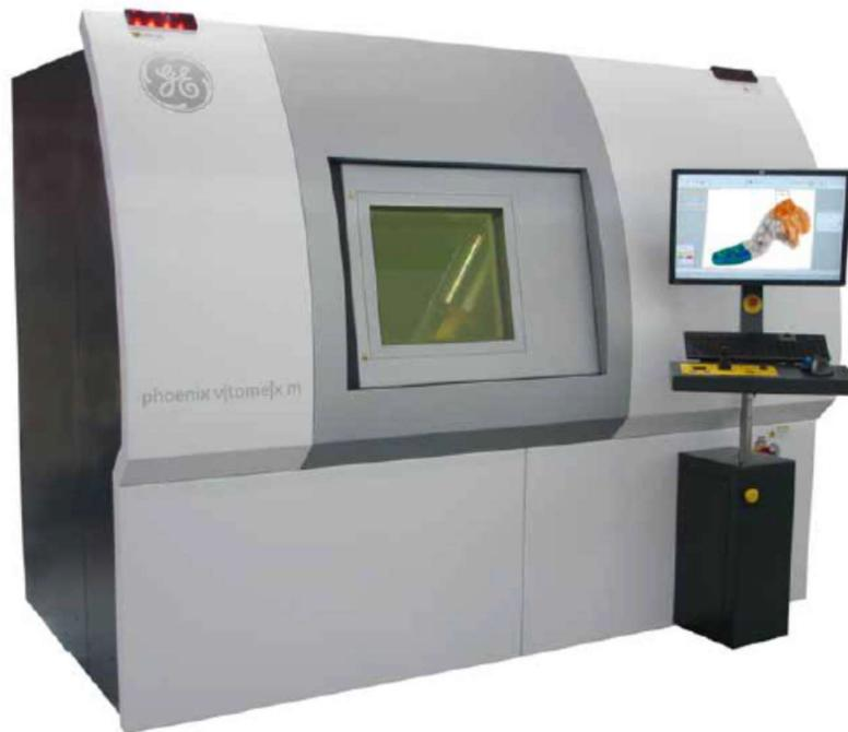
Figura 10 - TC industrial GE VTOMEX|M 300. Adaptado de[10].
