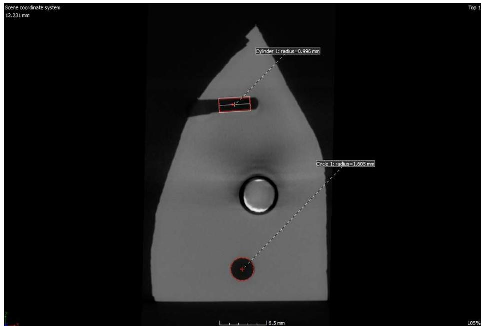
Figura 76 – Medição do raio dos furos no corpo de prova no volume filtrado.
