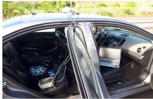
(b) OBU instalada no veículo.
