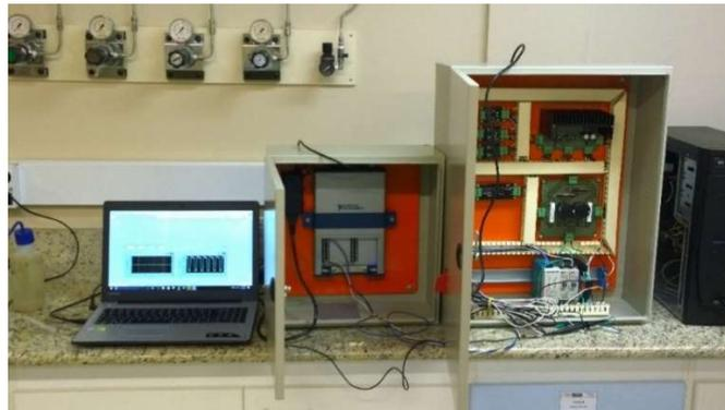
**Figura 3.6.** Sistema experimental completo. À esquerda, computador com o *software* desenvolvido em interface Labview, processando em tempo real. No meio, a interface de aquisição NI USB 6341. À direita, o conversor eletrônico de potência desenvolvido para amplificação do sinal proveniente do computador e para a medição de corrente drenada pela emulsão.
