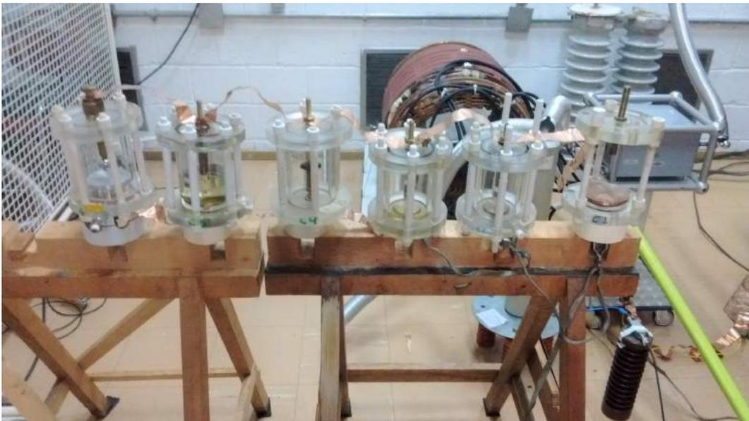
Figura 8.1: Todas as células de carga conectadas em paralelo.
