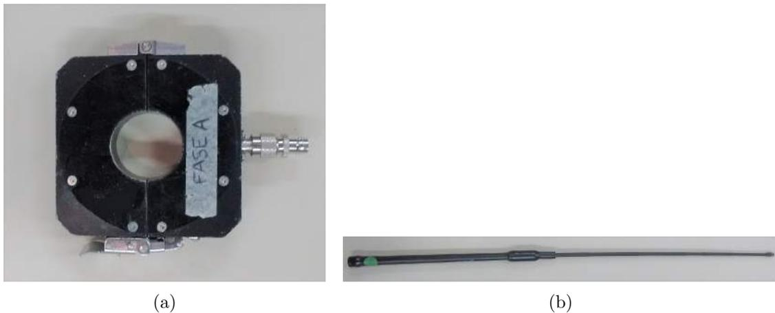
Figura 8.3: Sensores utilizados: (a) HFCT; (b) Antena Monopolo.
