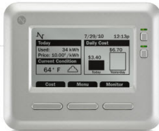
Figura 47 – IHD típico para uso em smart grid
