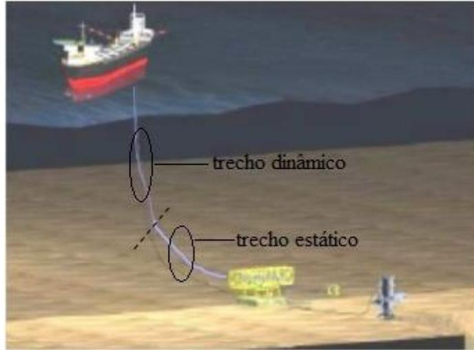
Figura 2.2 – Imagem ilustrativa mostrando os trechos dinâmico e estático de cabo de potência submarino alimentando um motor no fundo do mar.
