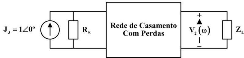
Figura 4-10. Rede de casamento de impedância com perdas.
