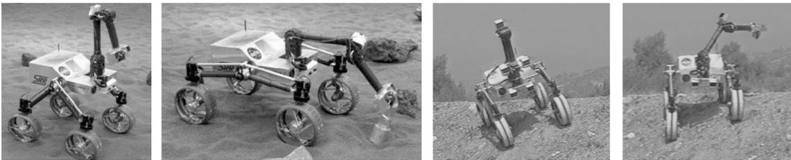
Figura 1.2: Robô *Sample Return Rover* desenvolvido pelo *Jet Propulsion Laboratory* para exploração espacial. O robô conta com mecanismo articulado do tipo *shoulder joints* com 2 DoF atuados.
