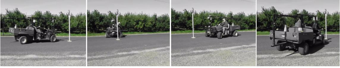
Figura 5.10: Procedimento de calibração do laser, que consiste em medir um ambiente conhecido de diferentes pontos de vista. O ambiente é formado por um plano horizontal com um poste vertical.
