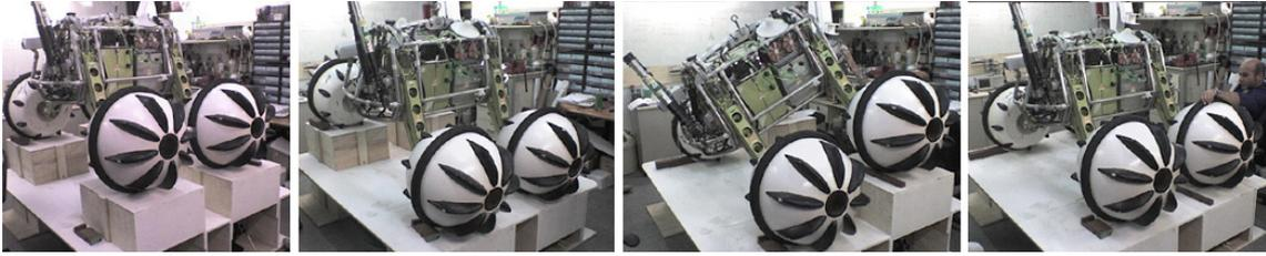
Figura 8.42: Robô Ambiental Híbrido sobre plataforma para emulação de terrenos irregulares. A plataforma permite alterar a altura e orientação do robô, simulando também obstáculos ultrapassados.
