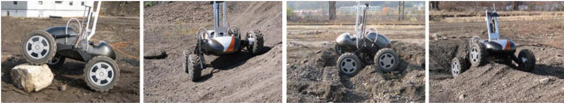
Figura 6.4: Reconfiguração do robô SCARAB, controlando o mecanismo a fim de manter o corpo do robô paralelo à horizontal.
