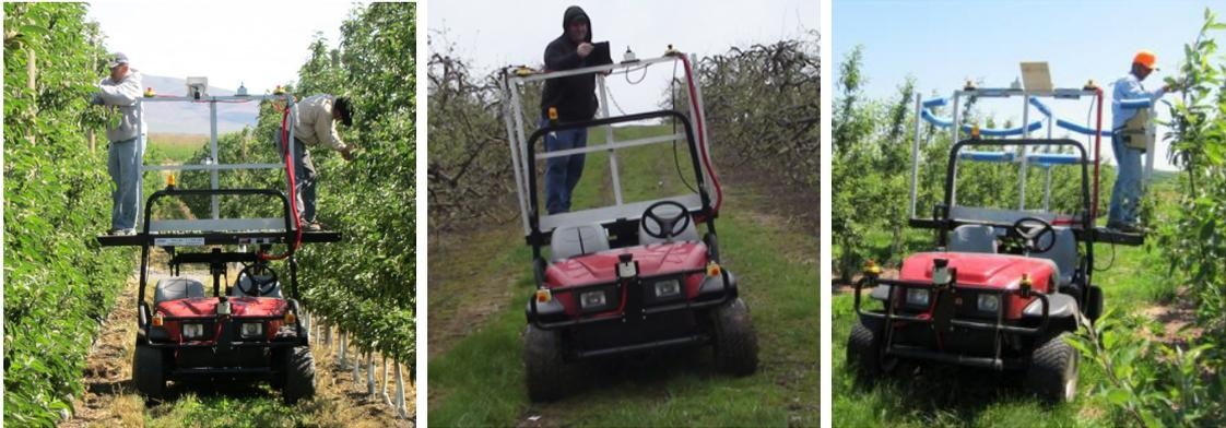
Figura 1.1: *Autonomous Prime Movers* desenvolvidos pelo *Robotics Institute - Carnegie Mellon University* para realização de tarefas agrícolas. Os veículos considerados possuem uma plataforma elevatória capaz de transportar até 2 operadores, constituindo um mecanismo com 1 DoF atuado.
