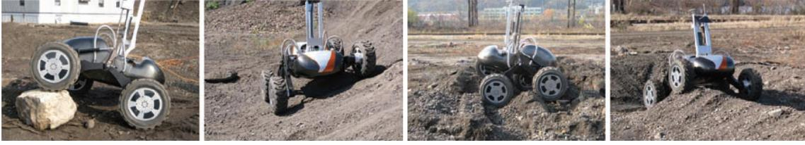
Figura 1.3: Robô SCARAB desenvolvido pelo *Robotics Institute - Carnegie Mellon University* para exploração lunar. O robô conta com mecanismo articulado do tipo *shoulder joints* com 2 DoF atuados.
