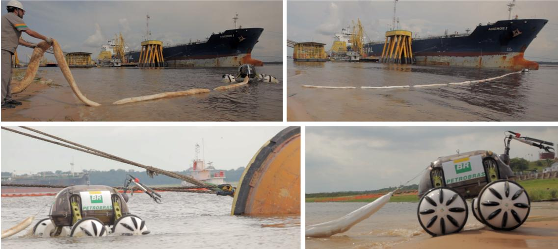
Figura 8.51: Robô Ambiental Híbrido puxando uma barreira de absorção de óleo de 40 m no rio Negro, durante um simulado de vazamento de óleo realizado durante o MOBEX Amazônia 2010. As imagens a esquerda destacam o efeito do controle de orientação, onde as pernas dianteiras e traseiras estão em diferentes configurações de forma a manter o robô paralelo à horizontal e melhorar o empuxo gerado pelas rodas na água.
