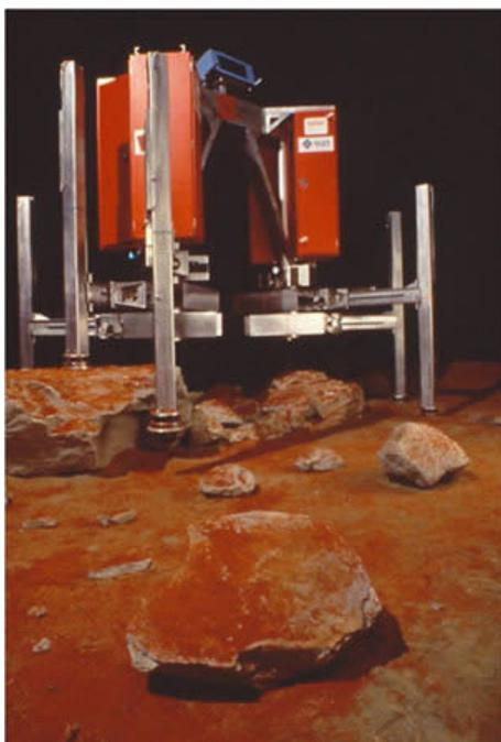
Figura 1.14: Robô Ambler desenvolvido pelo *Robotics Institute* (RI-CMU). O robô possui seis pernas, controladas de forma a garantir sua estabilidade.
