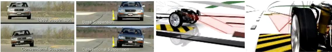
Figura 1.10: Exemplos de carros de passeio com suspensão ativa. Nas imagens da esquerda vemos testes realizados com o mecanismo de suspensão desenvolvido pela Bose. Nas imagens da direita vemos um carro Mercedes com suspensão ativa e tecnologia *pre-scan*, onde o perfil do terreno a ser percorrido é estimado com lasers.
