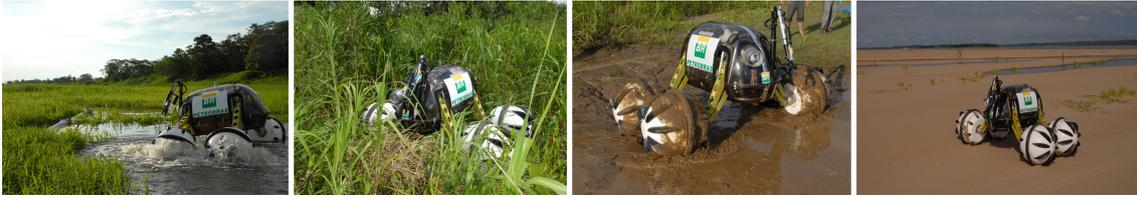
Figura 1.4: Robô Ambiental Híbrido desenvolvido pelo laboratório de Robótica do Cenpes/Petrobras para monitoração da floresta Amazônica. O robô possui suspensões independentes num total de 4 DoF atuados, capazes de adaptar o veículo aos diferentes terrenos percorridos.
