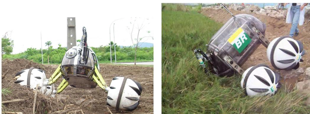
Figura 1.8: Rodas do Robô Ambiental Híbrido sem contato com o solo, durante operações na Ilha do Fundão, Rio de Janeiro.
