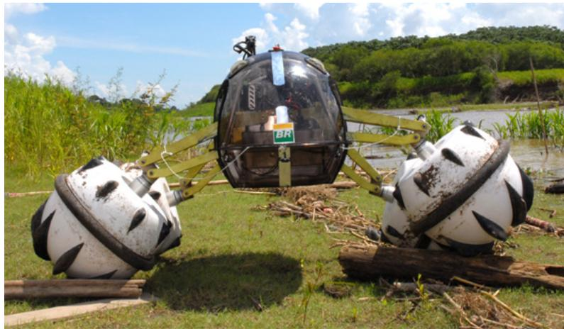
Figura 8.47: Robô Ambiental Híbrido em operação na floresta Amazônica, com uma roda apoiada em um tronco de árvore. O robô está utilizando o controle de orientação, que mantém seu corpo paralelo à horizontal.
