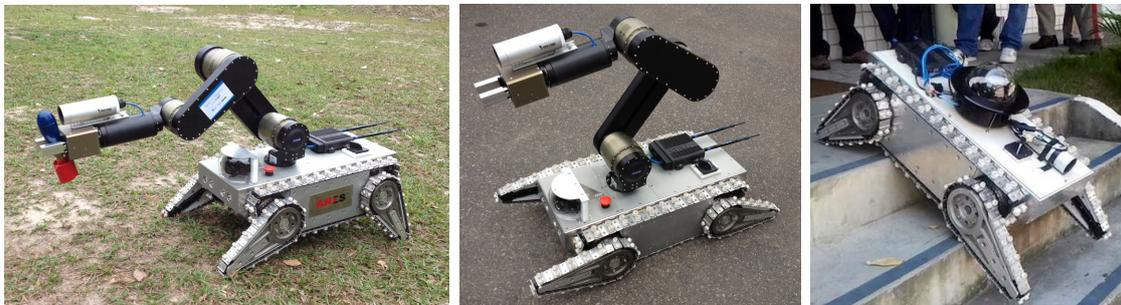
Figura 1.9: Robô DIANE, um dispositivo do tipo *Explosive Ordnance Disposal* (EOD) desenvolvido em parceria com a UFRJ. O robô conta com esteiras e braços de alavanca projetados para subir escadas, e também um braço manipulador com um *payload* de 10 kg. O mecanismo possui um total de 5 DoF atuados.
