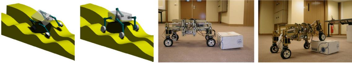
Figura 6.3: Reconfiguração do robô Hylos, controlando o mecanismo a fim de manter o corpo do robô paralelo à horizontal.
