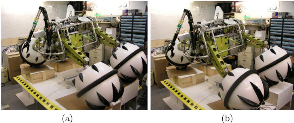
Figura 8.44: Teste de controle de tração, onde a plataforma emula uma depressão sob a roda dianteira esquerda: (a) Robô Ambiental Híbrido em configuração fixa onde uma roda perde contato com o terreno; (b) RAH reconfigurado conforme a estratégia de tração onde todas as rodas estão em contato com o terreno.
