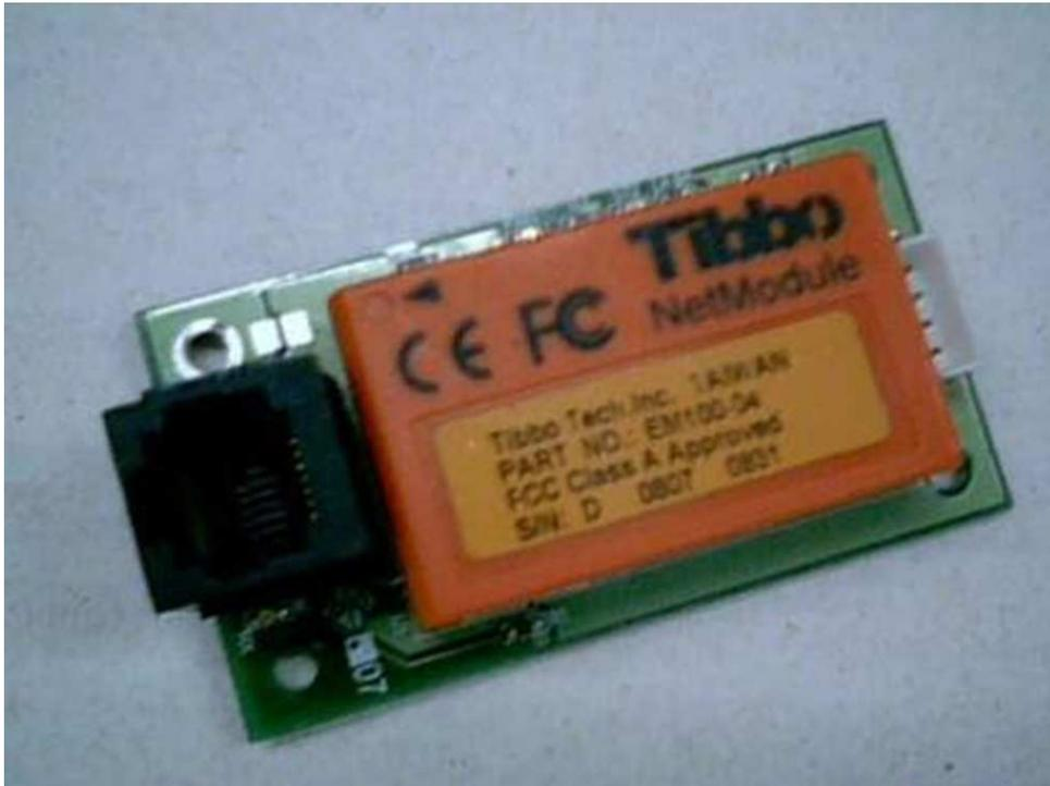
Figura 3.4: Protótipo da placa com o conversor *Ethernet*/Serial Tibbo EM-100.
