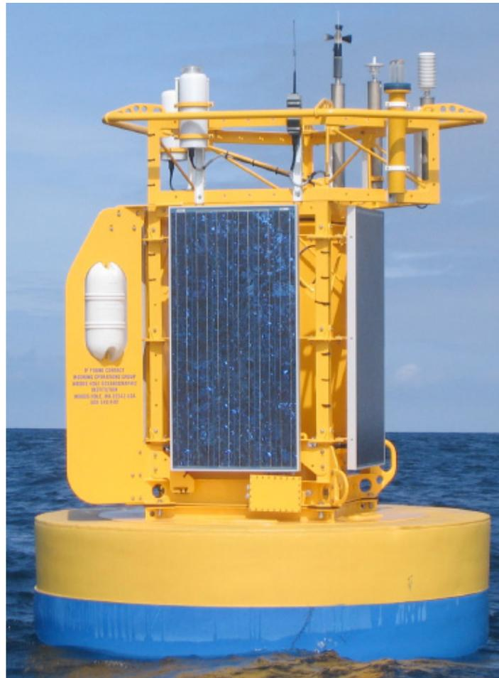
**Figura 4.10: Boia com GPS e antena de telemetria.**
