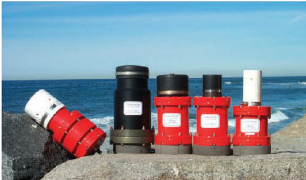
**Figura A.2: Modems acústicos da LinkQuest.**
