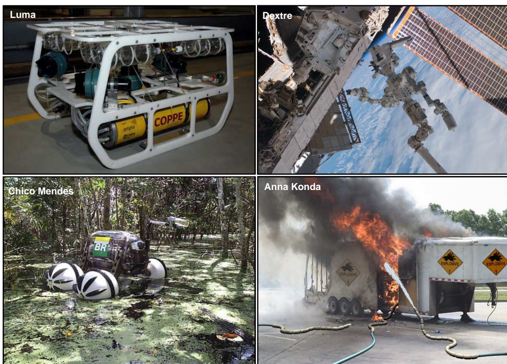
Figura 1.1: Sistemas robóticos para operação em ambientes hostis e pouco estruturados. Cortesia do GSCAR ( Luma ), Canadian Space Agency ( Dextre ), Cenpes/Petrobras ( Chico Mendes ) e SINTEF ( Anna Konda ).
