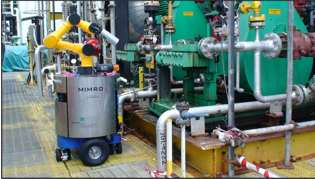
Figura 1.2: O robô MIMROex durante teste de campo em uma plataforma offshore . Cortesia da Fraunhofer IPA.
