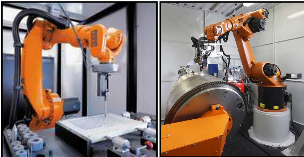
Figura 1.8: Exemplos de controle de força em aplicações industriais: à esquerda, perfuração; à direita, usinagem. Cortesia da KUKA Robotics.
