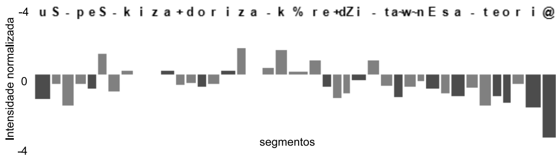
Figura 4.9: Gráfico da normalização da intensidade dos segmentos da sentença “Os professores acreditam nesta teoria”. A altura das barras indica o valor do fator de normalização e a largura indica o desvio-padrão das distribuições.
