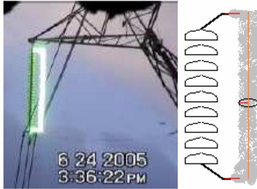
Figura 5.2.1.(6) – Arco em seu comprimento de referência
