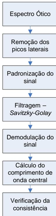
Figura 2 – Fluxograma do algoritmo para processamento e análise do espectro óptico
