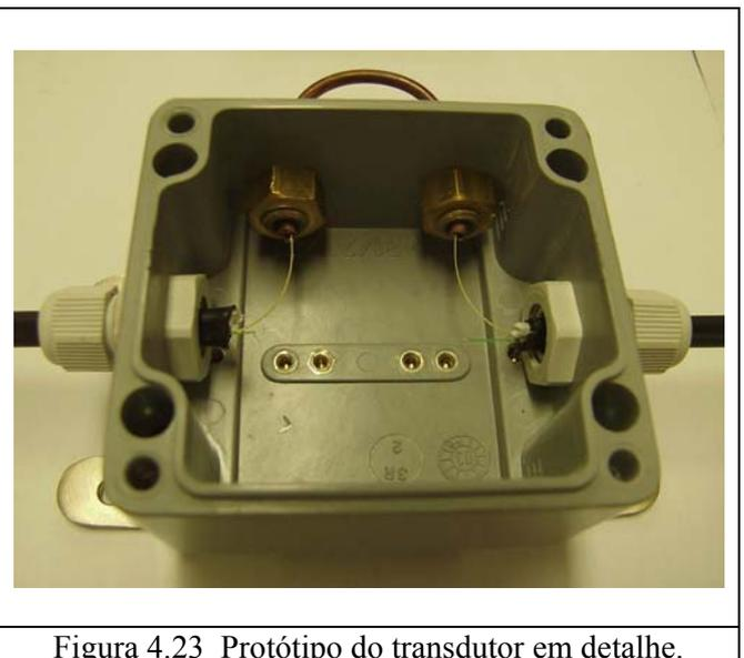
Figura 4.23 Protótipo do transdutor em detalhe.
