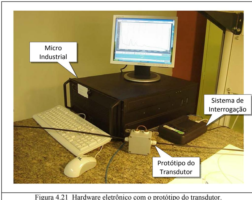
Figura 4.21 Hardware eletrônico com o protótipo do transdutor.
