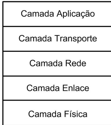
Figura 2.3: Pilha de protocolos utilizada pelos nós sensores.
