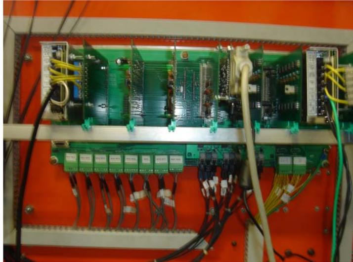
**Figura II-4: Instrumentação Principal - Fontes de Alimentação, Interface, kit de Desenvolvimento.**
