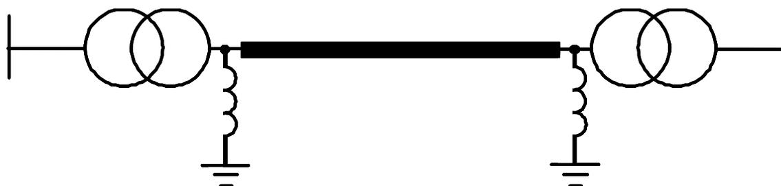
**Figura 1 - Esquema unifilar da transmissão HVCA trifásica.**
