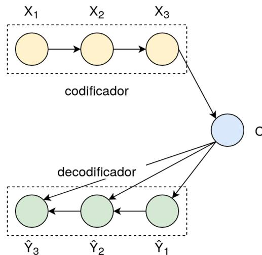
Figura 3.5: Arquitetura Encoder-Decoder, constituída por duas camadas de redes recorrentes: a de codificação e a de decodificação, ligadas por um conjunto de pesos  $C$ , que captura todo o contexto provindo da camada de codificação.
