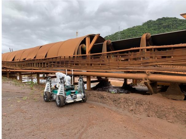
Figura 1.4: Rosi fazendo inspeção em uma correia transportadora no porto de Itaguaí.
