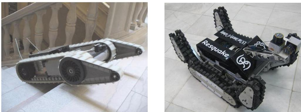
Figura 1.3: O robô similar ao Urbie usado em [29] à esquerda, equipado com uma pequena câmera monocular visível na foto. Na direita, o robô *Silver* usado em [27], com dois laser finders posicionados na horizontal e vertical.
