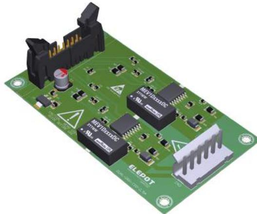
Figura 2.10: *Driver* isolado para disparo dos IGBTs.
