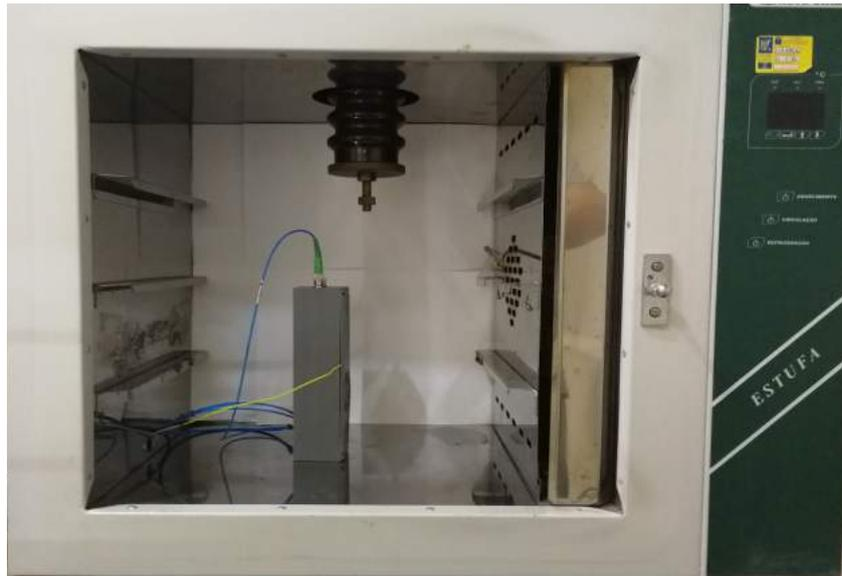
Figura 4.14: Calibração térmica do sensor.
