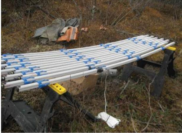
(a) Módulos do inclinômetro.
