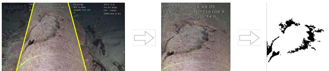
Figura 1.6: Preparação das imagens sequenciais de trechos de vídeos de inspeção: anotação manual das bordas dos dutos; remoção da distorção perspectiva; e anotação manual das anomalias (apenas nos dados de treinamento).
