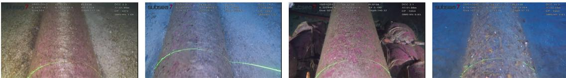
Figura 1.2: Exemplo de seções de dutos submarinos com superfície em boas condições.
