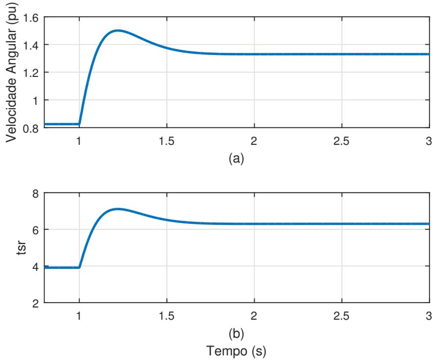
Figura 6.33: Resultados dinâmicos da simulação do DFIG acionado pelo DMC com MPRCC. (a) Velocidade angular e (b) *tip-speed-ratio*.
