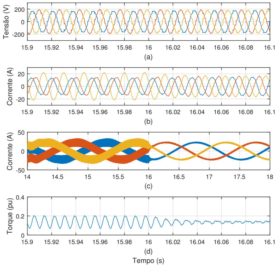
Figura 6.61: Instante em que inicia a compensação de desequilíbrio de tensão. (a) Tensão de estator, (b) corrente de estator, (c) corrente de rotor e (d) torque elétrico.
