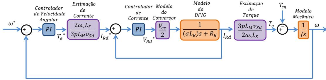
Figura 5.2: Diagrama de blocos para projeto de controle com estimação de corrente.
