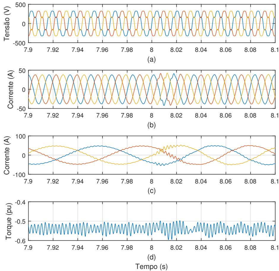
Figura 6.23: Resultados de simulação da compensação de correntes harmônicas de estator em transitório de frequência da rede indo de 59 Hz para 61 Hz. (a) Tensão de estator, (b) corrente de estator, (c) corrente de rotor e (d) torque elétrico.
