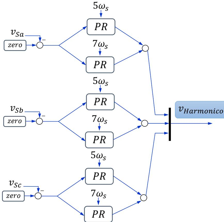
Figura 3.17: Diagrama de blocos da compensação de tensões harmônicas de estator.
