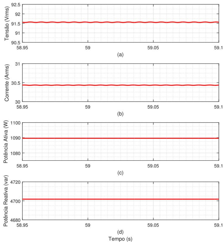
Figura 6.2: Resultados da simulação do ensaio de rotor bloqueado realizada no PSCAD/EMTDC. (a) Valor rms de tensão de linha, (b) valor rms de corrente de linha, (c) potência ativa e (d) potência reativa.
