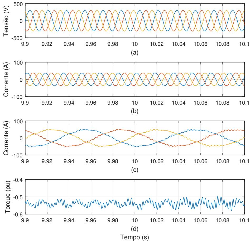
Figura 6.44: Resultados de simulação da compensação de tensões harmônicas de estator em transitório de frequência da rede indo de 60 Hz para 59 Hz. (a) Tensão de estator, (b) corrente de estator, (c) corrente de rotor e (d) torque elétrico.
