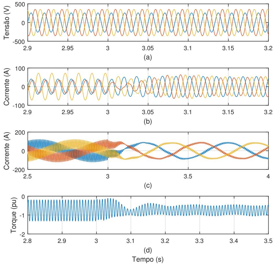
Figura 6.24: Resultados de simulação da compensação de desequilíbrio da corrente de estator. (a) Tensão de estator, (b) corrente de estator, (c) corrente de rotor e (d) torque elétrico.
