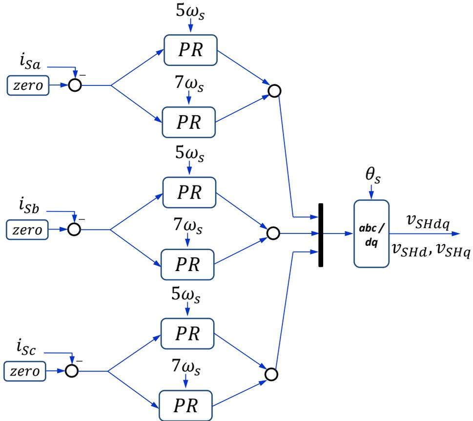
Figura 3.3: Controle de compensação de componentes harmônicas de corrente de estator, através do uso de controladores ressonantes dedicados.
