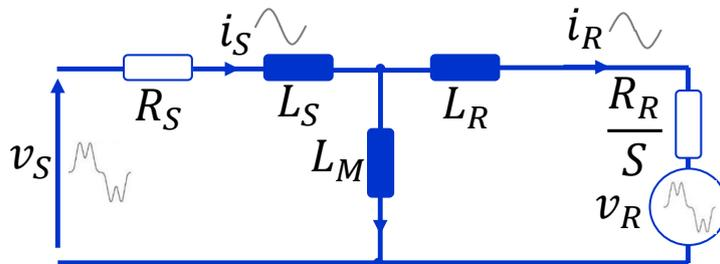
Figura 3.5: Circuito equivalente do DFIG.
