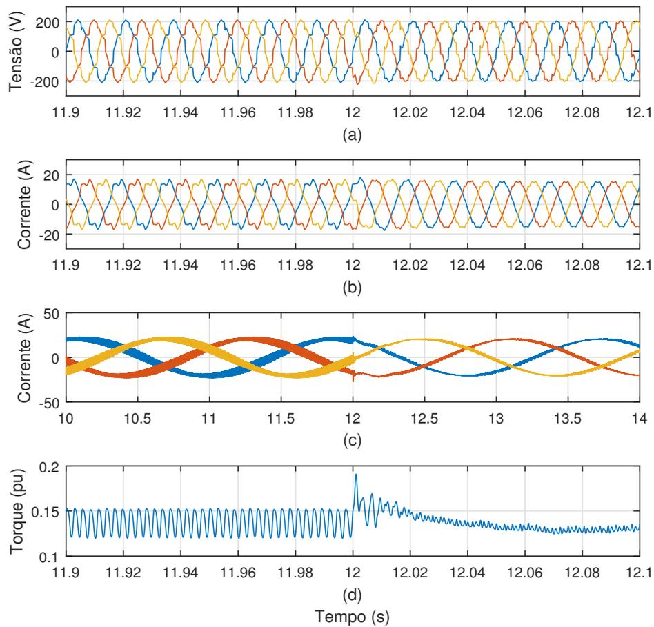
Figura 6.59: Instante em que inicia a compensação de tensões harmônicas de estator. (a) Tensão de estator, (b) corrente de estator, (c) corrente de rotor e (d) torque elétrico.
