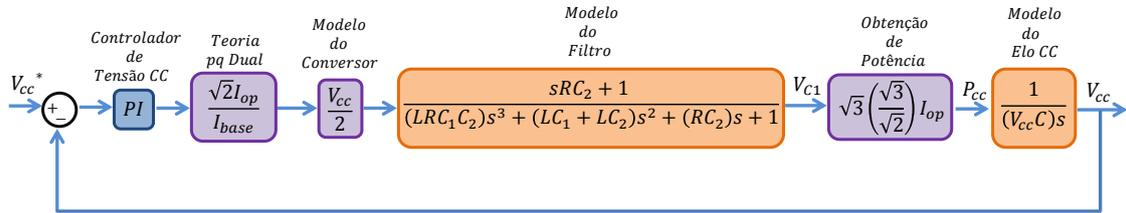
Figura 5.18: Diagrama de blocos do modelo linear do conversor do lado da rede conectado em série, para projeto de controle.
