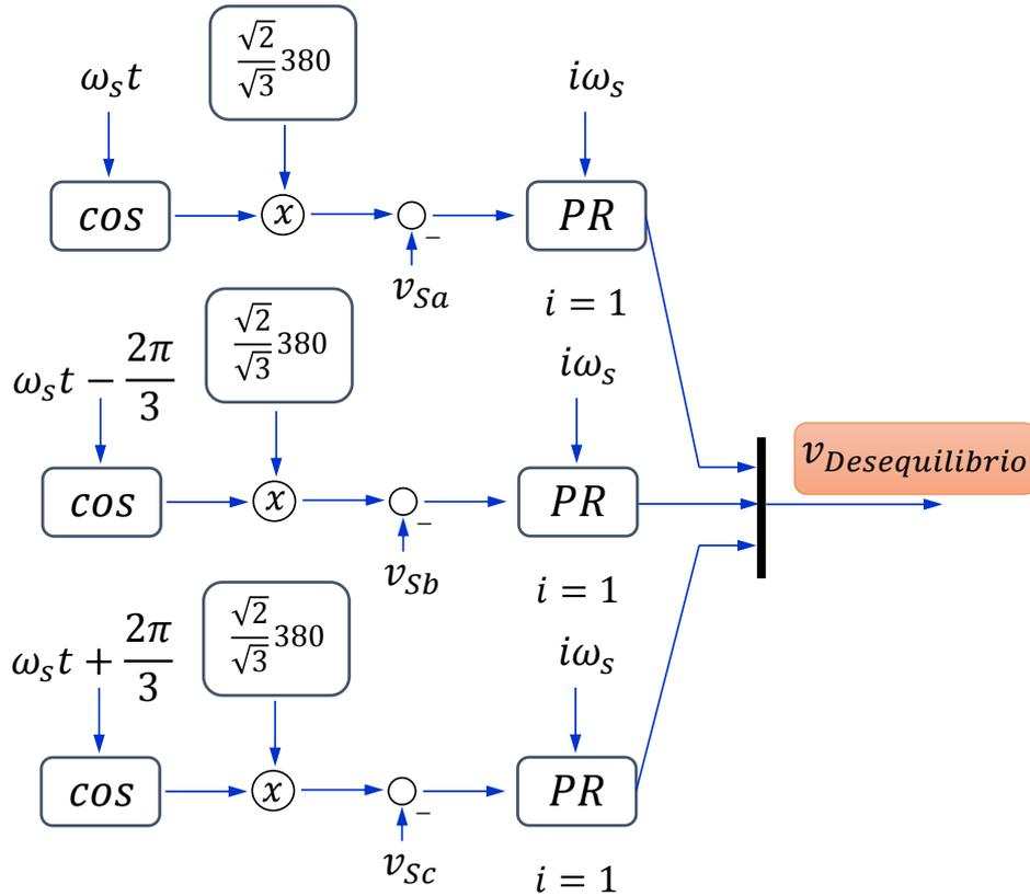
Figura 3.18: Diagrama de blocos da compensação de tensões desequilibradas de estator.
