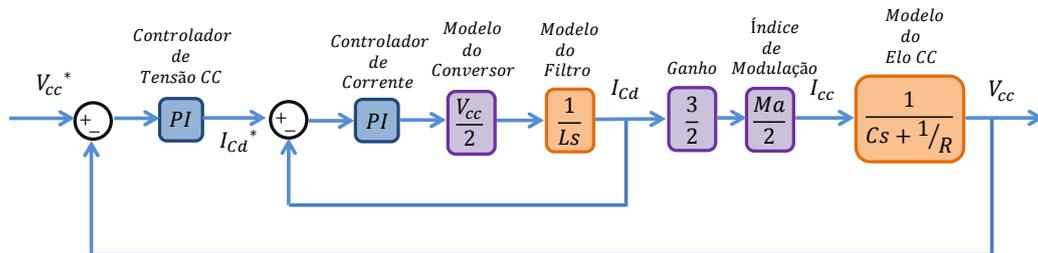
Figura 5.8: Diagrama de blocos com o modelo linear para o projeto do controle de regulação do elo CC.
