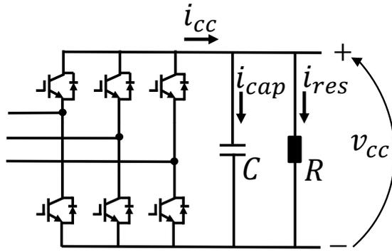
Figura 5.7: Representação para a obtenção do modelo do elo de corrente contínua.
