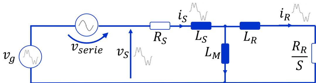
Figura 6.54: Circuito equivalente de uma máquina de indução gaiola de esquilo, com conversor do lado da rede conectado em série, com compensação desabilitada.
