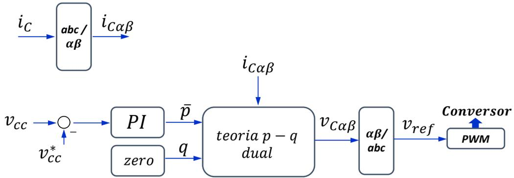
Figura 5.14: Diagrama de controle da regulação do elo CC através do conversor do lado da rede conectado em série.
