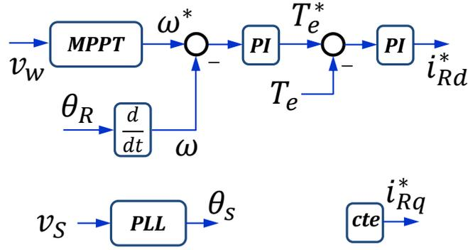
Figura 3.2: Controle de componente fundamental da corrente de rotor, referente ao controle de potência ativa e potência reativa de estator.
