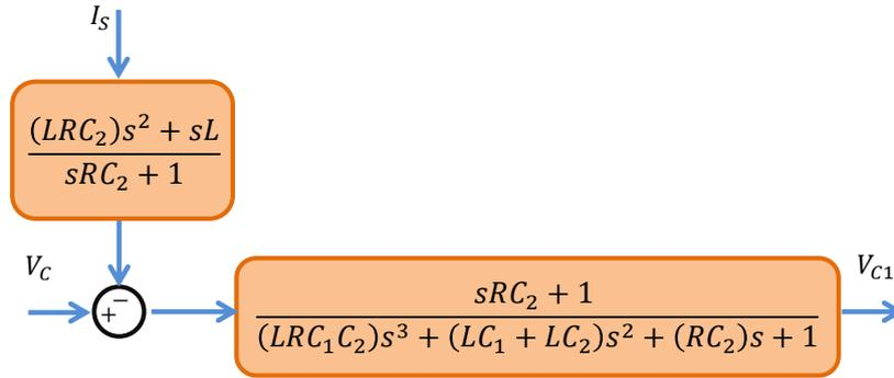
Figura 5.17: Outra representação do diagrama de blocos da função de transferência  $\frac{V_{C1}}{V_C}$ .
