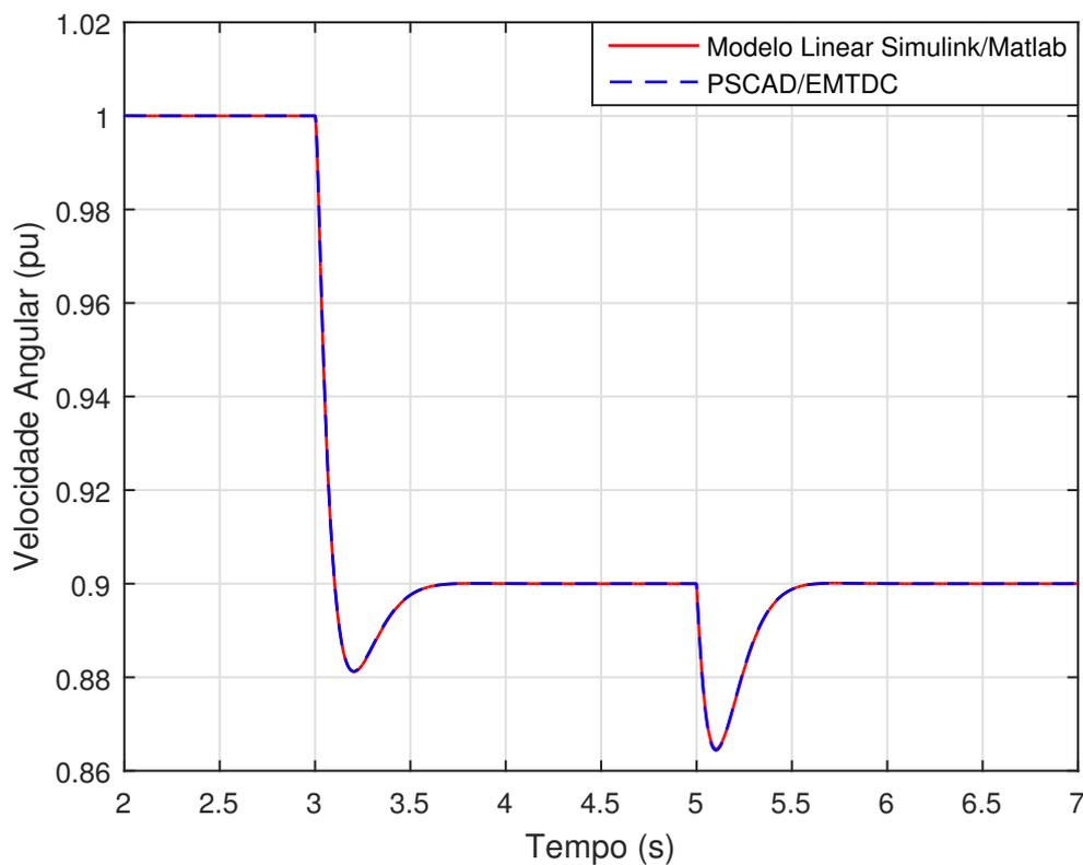
Figura 6.9: Comparação entre resultados do modelo linear simulado no Simulink/Matlab e modelo real simulado no PSCAD/EMTDC.
