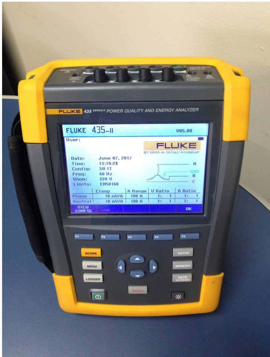
Figura 4.4: Medidor de qualidade de energia.
