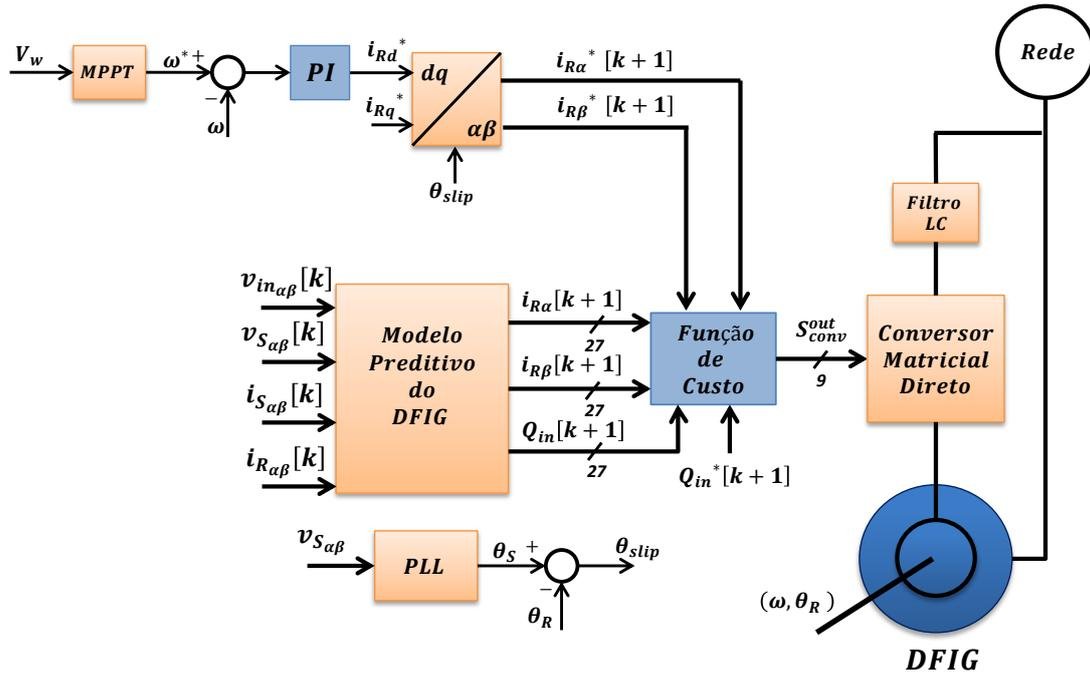
Figura 3.11: Diagrama de controle do método preditivo.
