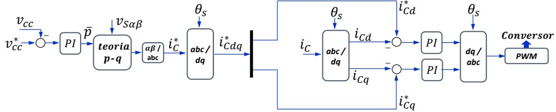
Figura 5.5: Diagrama de controle da regulação do elo de corrente contínua em um conversor do lado da rede conectado em paralelo.
