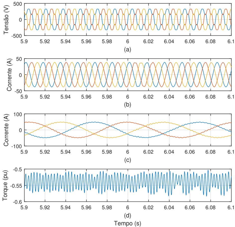
Figura 6.22: Resultados de simulação da compensação de correntes harmônicas de estator em transitório de frequência da rede indo de 60 Hz para 59 Hz. (a) Tensão de estator, (b) corrente de estator, (c) corrente de rotor e (d) torque elétrico.
