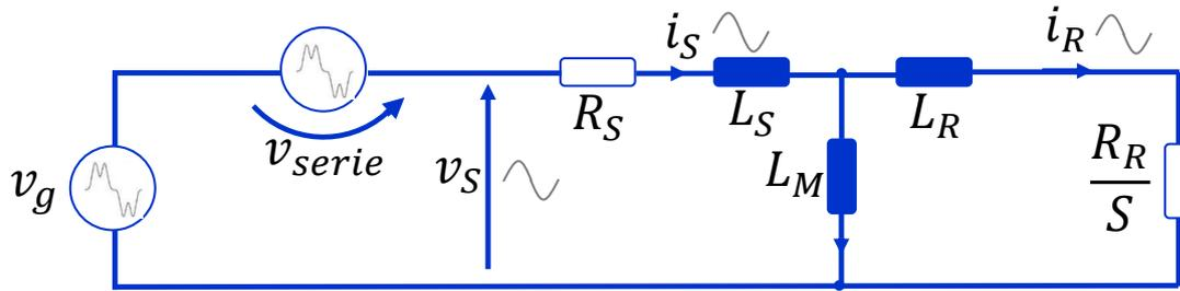
Figura 6.55: Circuito equivalente de uma máquina de indução gaiola de esquilo, com conversor do lado da rede conectado em série, com compensação habilitada.
