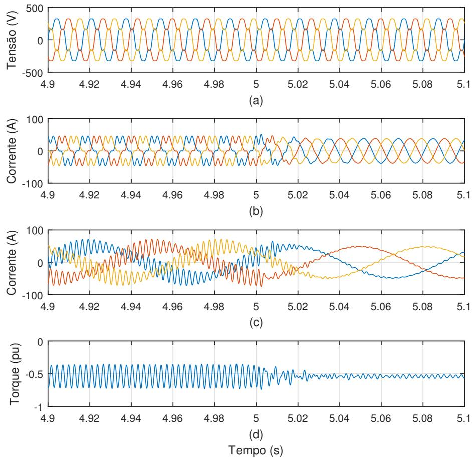
Figura 6.20: Resultados de simulação da compensação de correntes harmônicas de estator. (a) Tensão de estator, (b) corrente de estator, (c) corrente de rotor e (d) torque elétrico.
