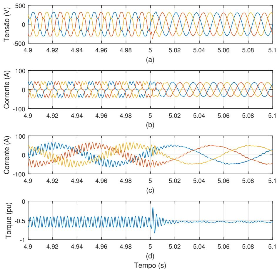
Figura 6.42: Resultados de simulação da compensação de tensões harmônicas de estator. (a) Tensão de estator, (b) corrente de estator, (c) corrente de rotor e (d) torque elétrico.
