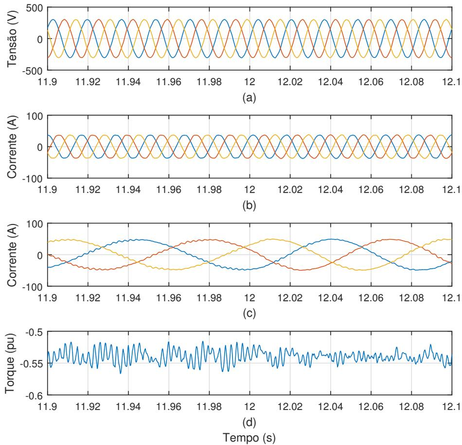
Figura 6.45: Resultados de simulação da compensação de tensões harmônicas de estator em transitório de frequência da rede indo de 59 Hz para 61 Hz. (a) Tensão de estator, (b) corrente de estator, (c) corrente de rotor e (d) torque elétrico.
