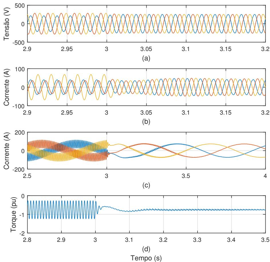
Figura 6.46: Resultados de simulação da compensação de desequilíbrio da tensão de estator. (a) Tensão de estator, (b) corrente de estator, (c) corrente de rotor e (d) torque elétrico.
