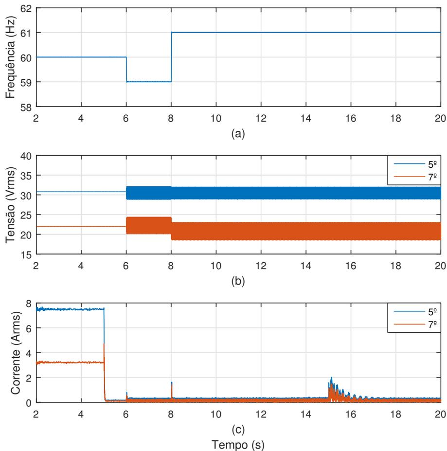
Figura 6.21: Resultados referentes a variações de frequência da rede. (a) Frequência da rede, (b) valor rms de componentes de 5° e 7° harmônico da tensão de estator e (c) valor rms de componentes de 5° e 7° harmônico da corrente de estator.
