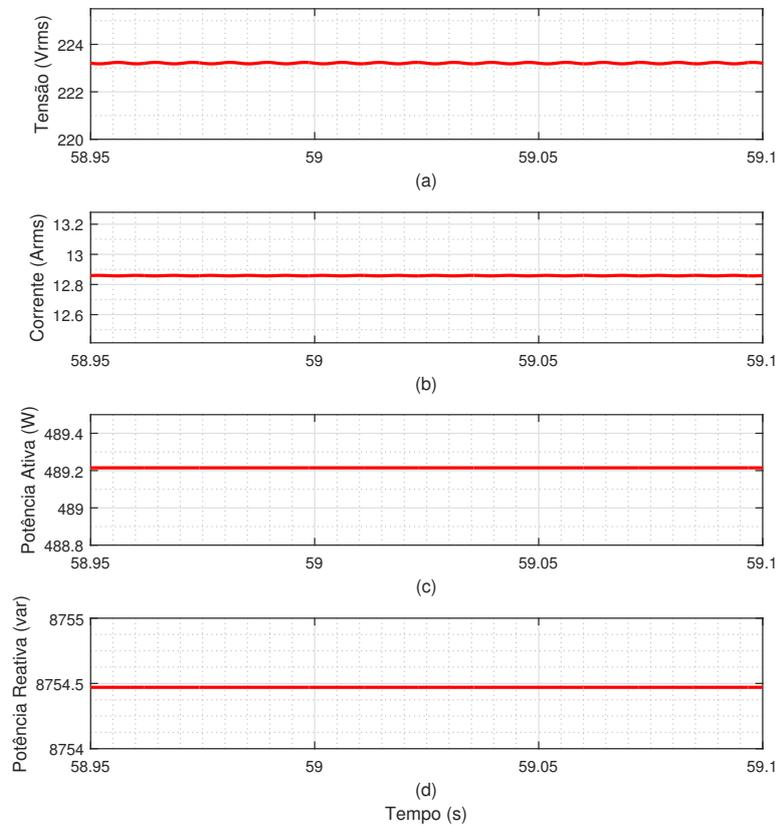
Figura 6.4: Resultados da simulação do ensaio a vazio realizada no PSCAD/EMTDC. (a) Valor rms de tensão de fase, (b) valor rms de corrente de fase, (c) potência ativa e (d) potência reativa.
