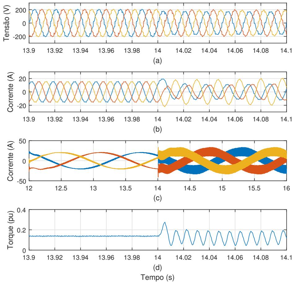
Figura 6.60: Instante em que inicia a presença de desequilíbrio na tensão do ponto de acoplamento do sistema eólico. (a) Tensão de estator, (b) corrente de estator, (c) corrente de rotor e (d) torque elétrico.
