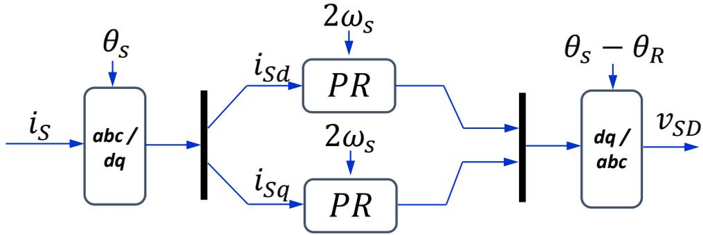
Figura 3.6: Compensação de desequilíbrio de corrente de estator.
