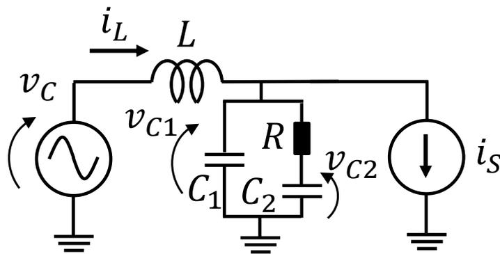
Figura 5.15: Circuito equivalente do conversor do lado da rede conectado em série.
