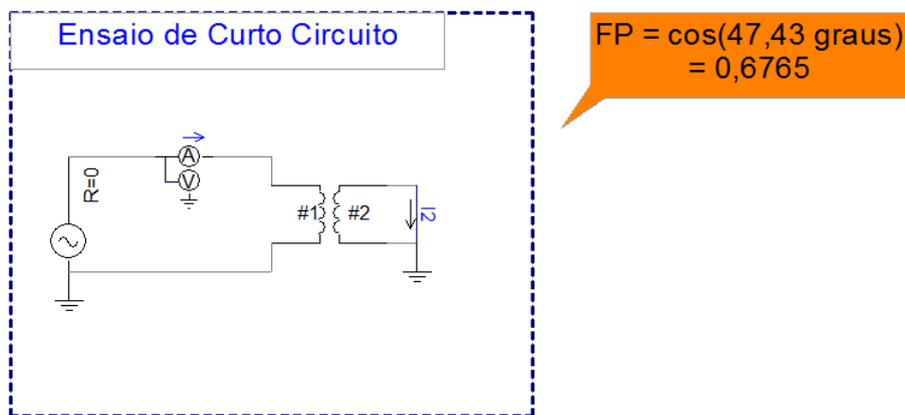
Figura 6.5: Simulação do ensaio de curto-circuito realizada no PSCAD/EMTDC.
