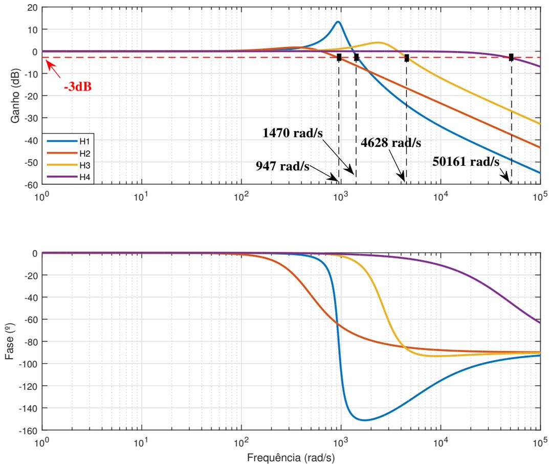
Figura 6.28: Diagramas de Bode de malha fechada.
