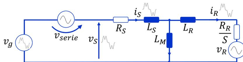
Figura 3.14: Circuito equivalente do DFIG com conversor série sem compensação.
