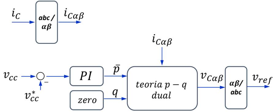
Figura 3.16: Diagrama de blocos do controle da regulação do elo de corrente contínua.
