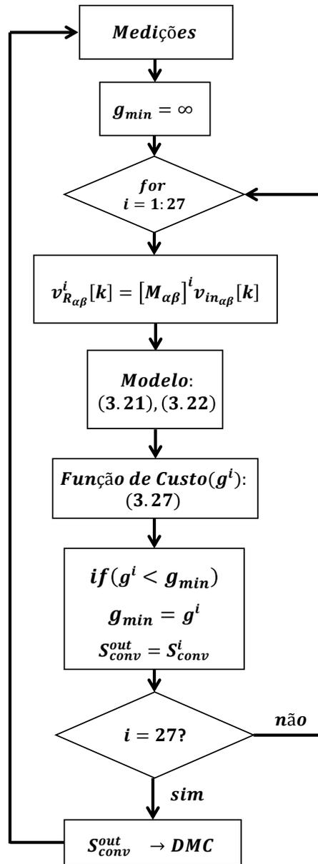
Figura 3.10: Fluxograma do algoritmo preditivo.
