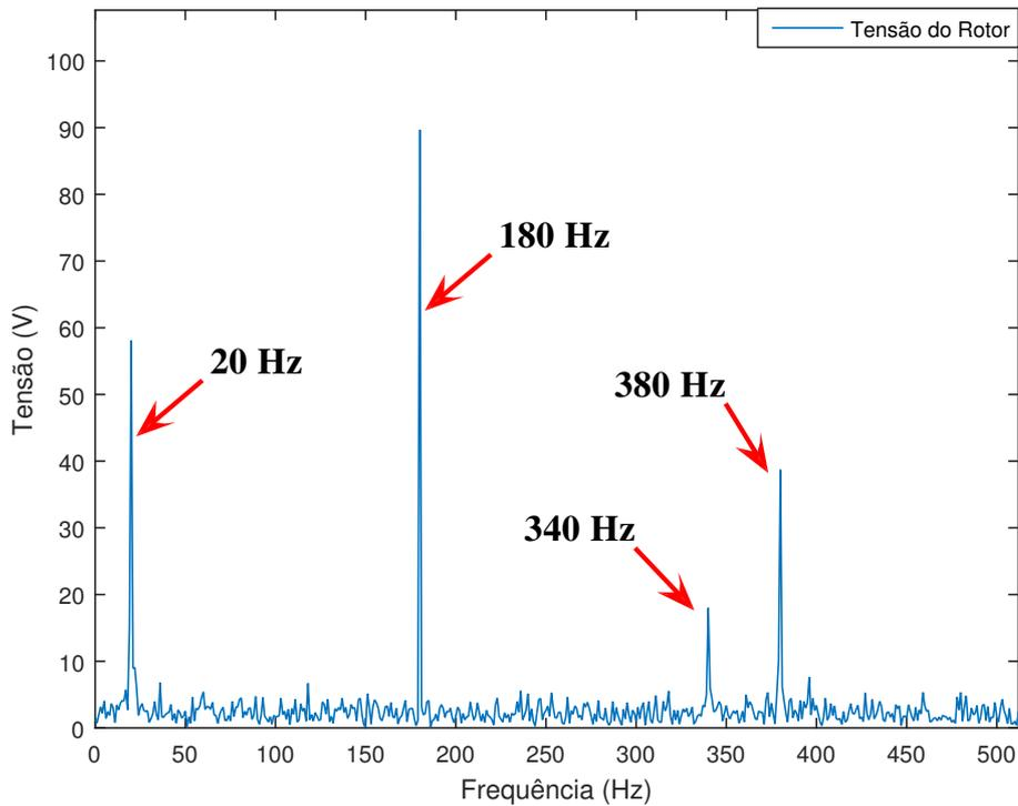
Figura 6.35: Resultado da aplicação de uma FFT na fase *a* da tensão do rotor.
