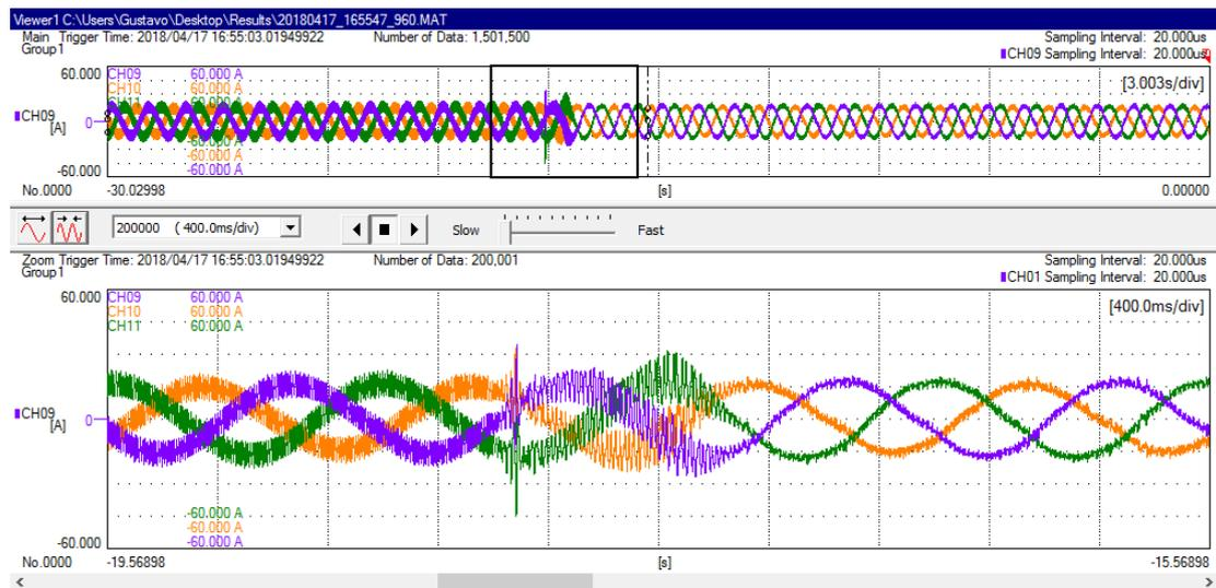
Figura 8.11: Corrente de rotor no instante em que o controle de compensação de desequilíbrio é habilitado.
