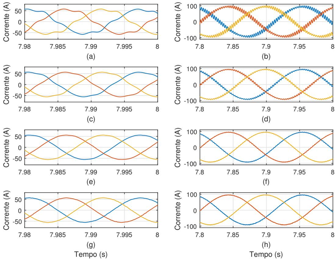
Figura 6.30: Resultados de simulação da compensação de correntes harmônicas de estator, através do ajuste apropriado dos controladores lineares de corrente. (a) Corrente de estator para  $H_1(s)$ , (b) corrente de rotor para  $H_1(s)$ , (c) corrente de estator para  $H_2(s)$ , (d) corrente de rotor para  $H_2(s)$ , (e) corrente de estator para  $H_3(s)$ , (f) corrente de rotor para  $H_3(s)$ , (g) corrente de estator para  $H_4(s)$  e (h) corrente de rotor para  $H_4(s)$ .
