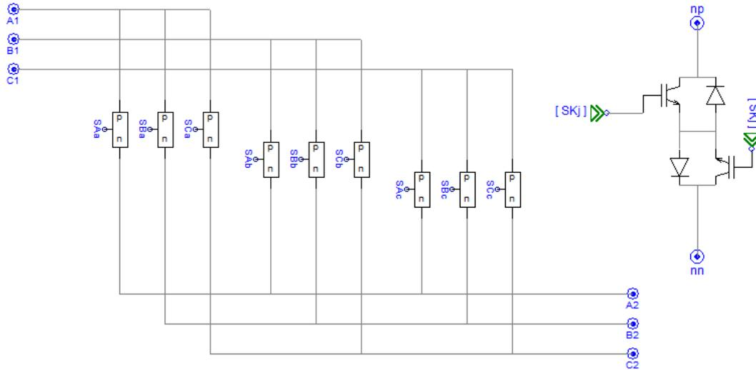
Figura 6.32: Detalhe do conversor matricial direto e da chave bidirecional, implementados no PSCAD/EMTDC.
