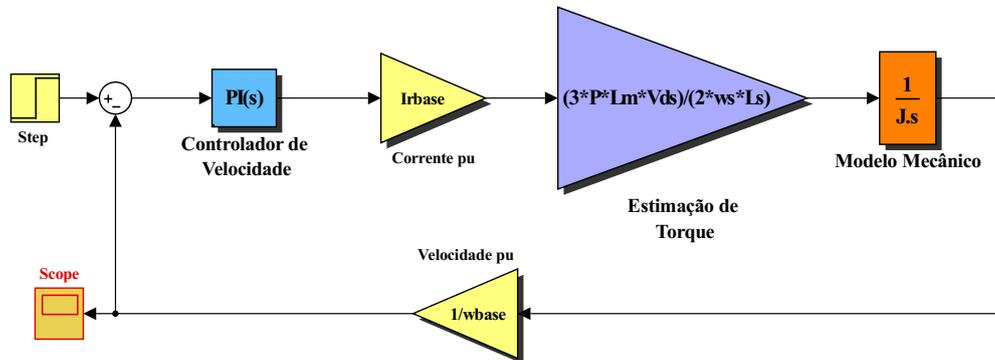
Figura 5.12: Projeto de controle realizado no Simulink/Matlab.
