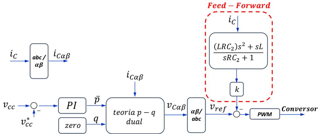
Figura 5.21: Diagrama de controle da regulação do elo CC através do conversor do lado da rede conectado em série adicionando-se o termo do *feed-forward*.
