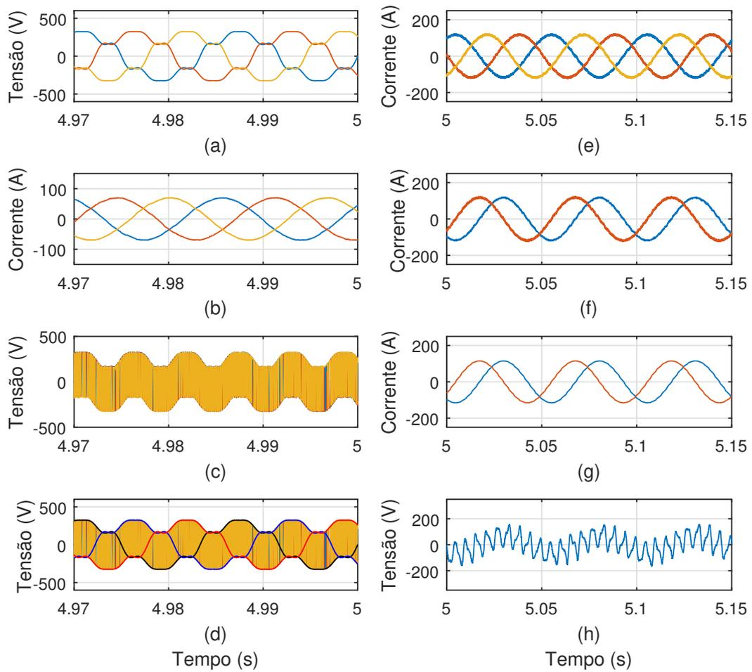
Figura 6.34: Resultados da compensação de correntes harmônicas da simulação do DFIG acionado pelo DMC com MPRCC. (a) Tensão de estator, (b) corrente de estator, (c) fase  $a$  da tensão do rotor, (d) fase  $a$  da tensão do rotor e envelope da tensão de entrada, (e) corrente de rotor, (f) corrente de rotor em  $\alpha\beta$ , (g) referência de corrente de rotor em  $\alpha\beta$  e (h) fase  $a$  da tensão do rotor, desprezando-se as componentes harmônicas de altas frequências.
