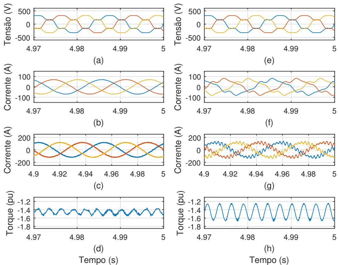
Figura 6.39: DFIG acionado por DMC com MPRCC. (a) Tensão de estator, (b) corrente de estator, (c) corrente de rotor, (d) torque elétrico. DFIG acionado por *back-to-back* com controladores lineares de corrente de rotor. (e) Tensão de estator, (f) corrente de estator, (g) corrente de rotor, (h) torque elétrico.
