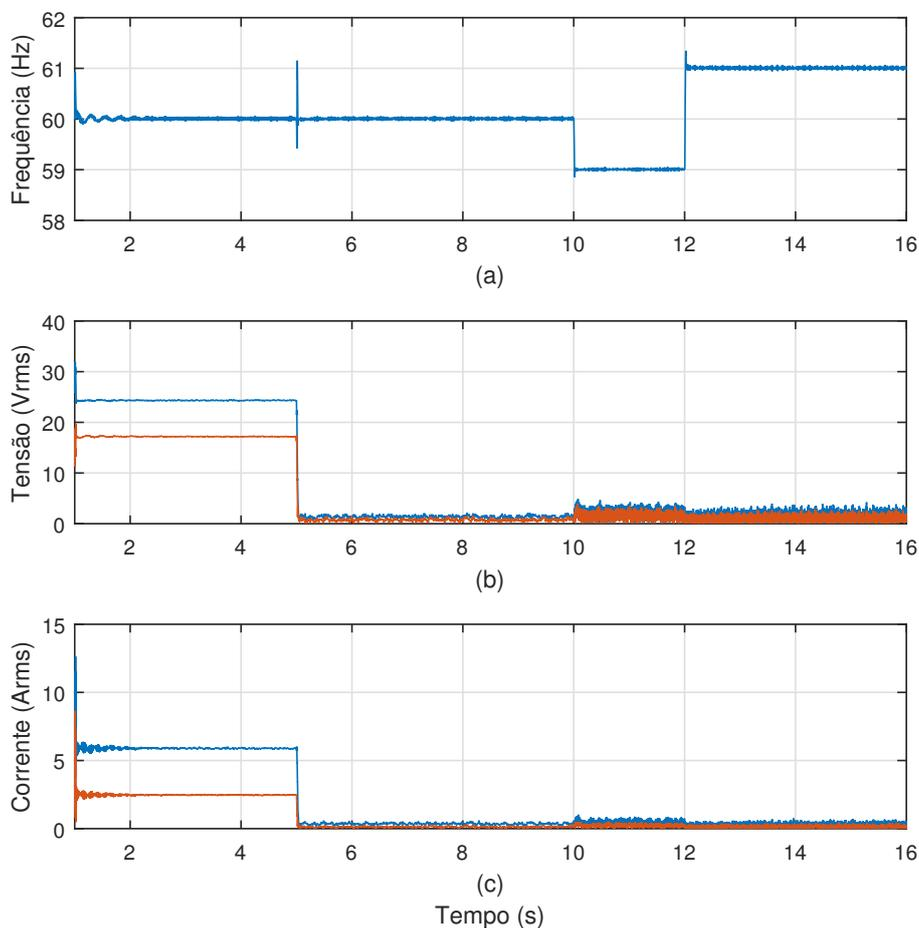
Figura 6.43: Resultados referentes à variações de frequência da rede. (a) Frequência da rede, (b) valor rms de componentes de 5º e 7º harmônico da tensão de estator e (c) valor rms de componentes de 5º e 7º harmônico da corrente de estator.
