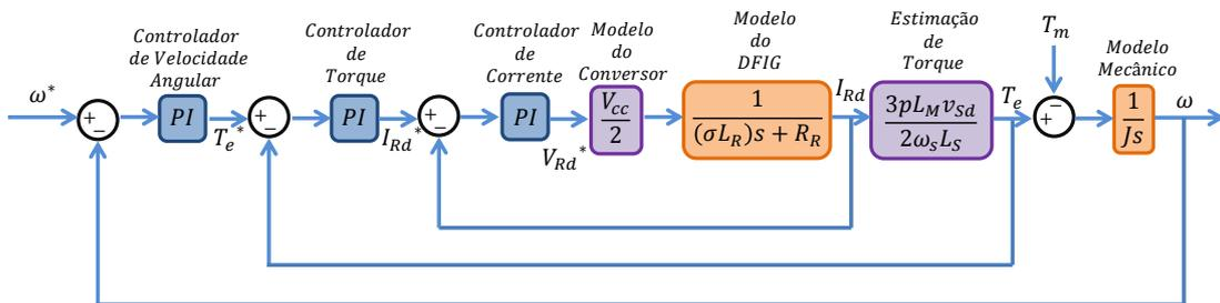
Figura 5.1: Diagrama de blocos para projeto de controle com controlador de torque.
