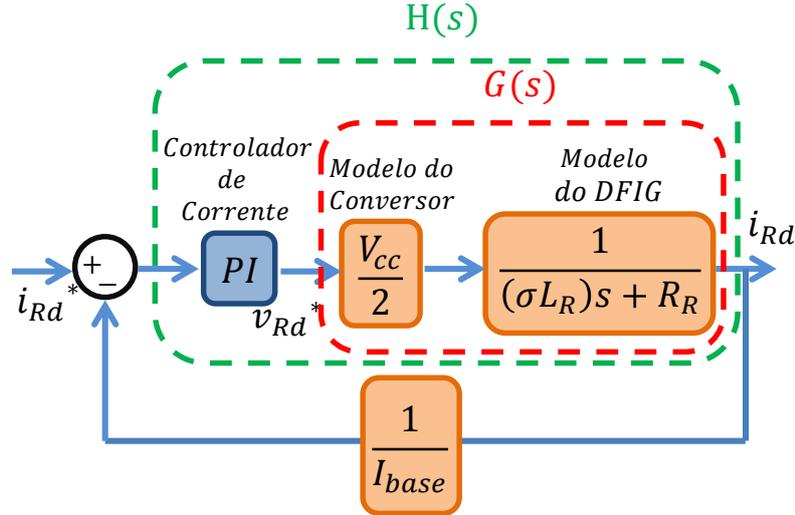
Figura 6.25: Malha mais interna do controle de velocidade do DFIG, correspondendo a malha de corrente de rotor.
