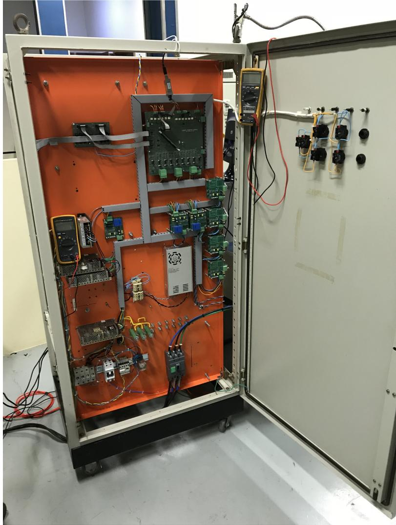
Figura 7.2: Circuitos auxiliares do conversor.
