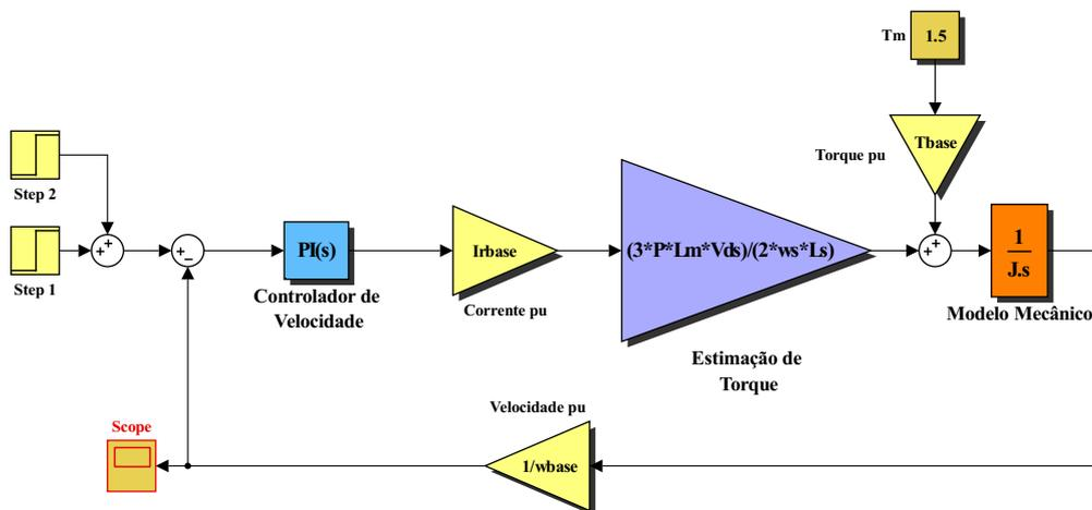
Figura 6.13: Simulação do DMC com MPRCC no modelo linear do Simulink/Matlab.
