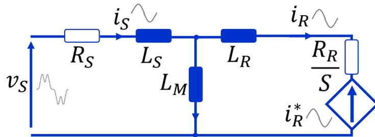
Figura 3.12: Circuito equivalente do DFIG quando acionado por um DMC com controle preditivo de corrente de rotor.
