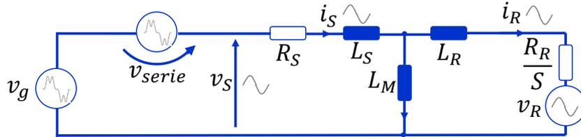
Figura 3.15: Circuito equivalente do DFIG com conversor série com compensação.
