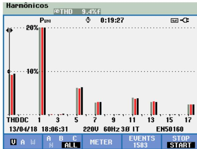
Figura 8.7: THD e amplitude das componentes harmônicas da tensão de estator, antes do início da compensação harmônica.
