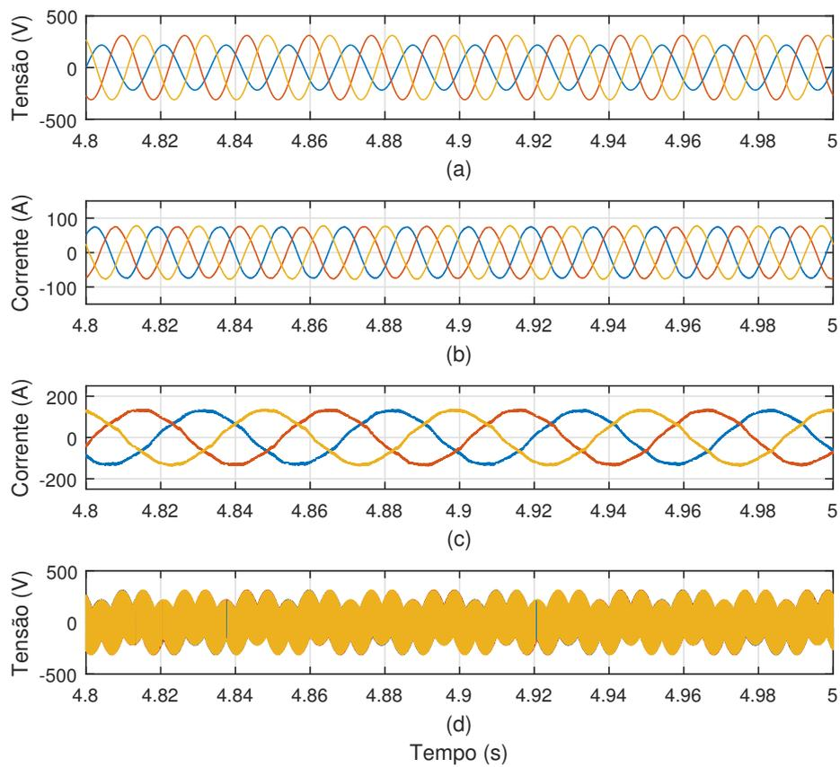
Figura 6.36: Resultados da compensação de desequilíbrio de corrente da simulação do DFIG acionado pelo DMC com MPRCC. (a) Tensão de estator, (b) corrente de estator, (c) corrente de rotor e (d) fase  $a$  da tensão do rotor.
