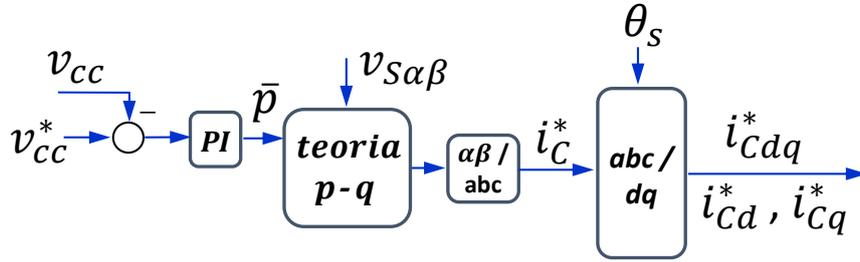
Figura 3.7: Geração da referência de corrente do conversor, para a regulação do elo de corrente contínua.
