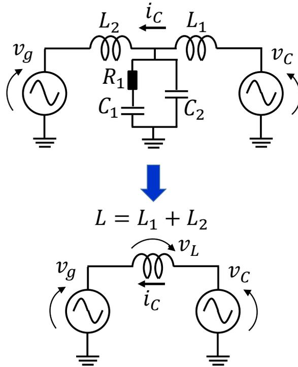
Figura 5.6: Modelo do filtro completo e simplificado.
