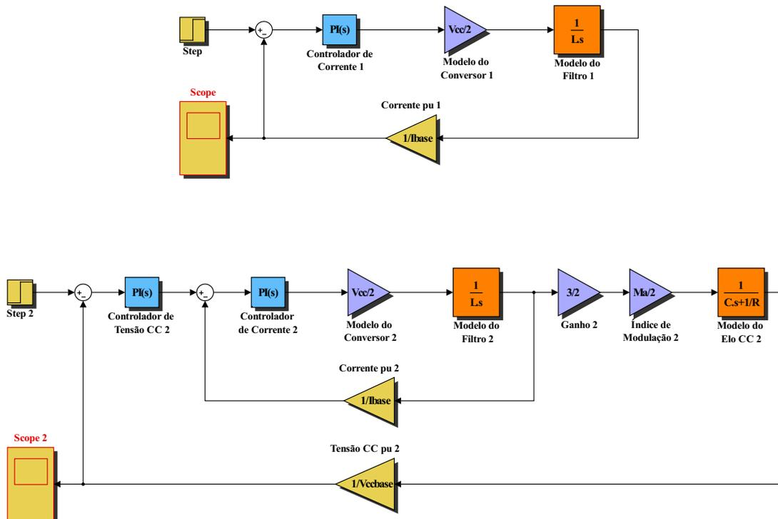
Figura 5.9: Projeto de controle realizado no Simulink/Matlab.
