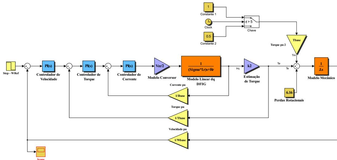
Figura 6.7: Simulação do controle do conversor do lado do rotor no modelo linear do Simulink/Matlab.
