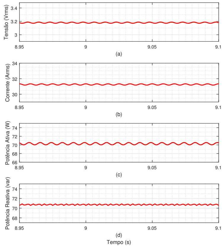
Figura 6.6: Resultados da simulação do ensaio de curto-circuito realizada no PS-CAD/EMTDC. (a) Valor rms de tensão de linha, (b) valor rms de corrente de linha, (c) potência ativa e (d) potência reativa.
