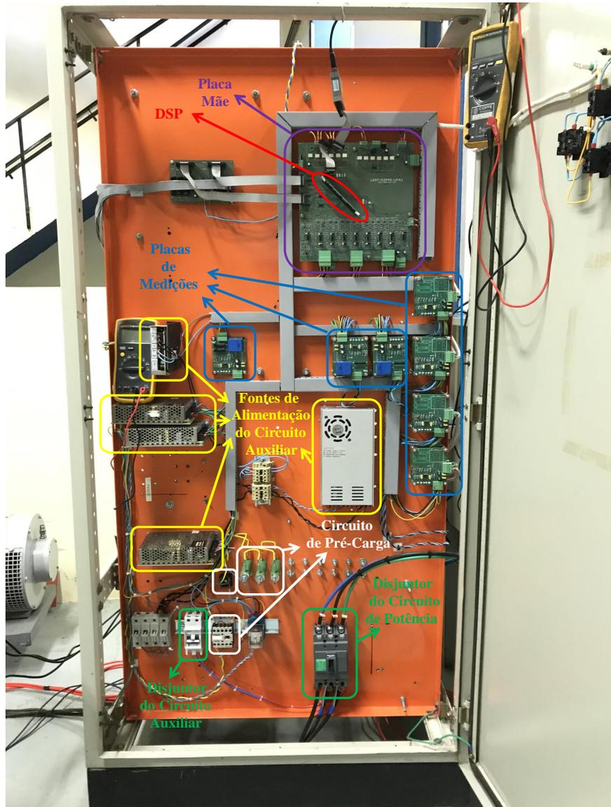
Figura 7.3: Detalhamento dos circuitos auxiliares do conversor.
