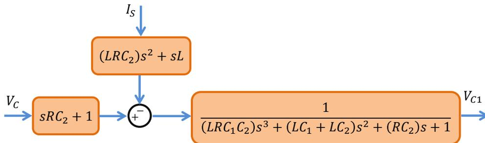
Figura 5.16: Diagrama de blocos da função de transferência  $\frac{V_{C1}}{V_C}$ .
