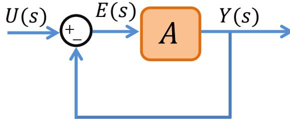
Figura 6.26: Função de transferência arbitrária em malha fechada.
