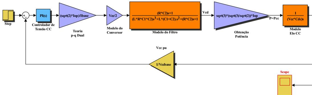
Figura 5.19: Diagrama de blocos do modelo linear do conversor do lado da rede conectado em série, para projeto de controle, implementado no Simulink/Matlab.
