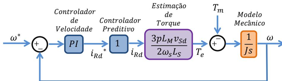
Figura 5.11: Modelo linear para projeto de controle do controlador de velocidade angular em um DMC com MPRCC acionando um DFIG.
