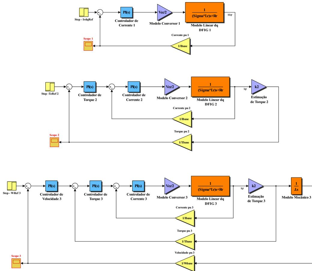
Figura 5.3: Projeto de controle realizado no Simulink/Matlab.
