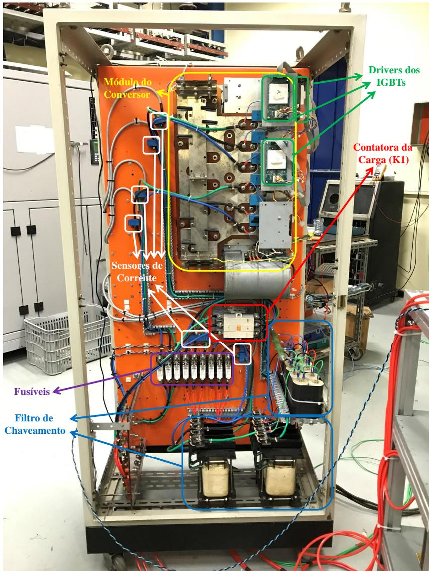
Figura 7.5: Detalhamento do circuito de potência do conversor.
