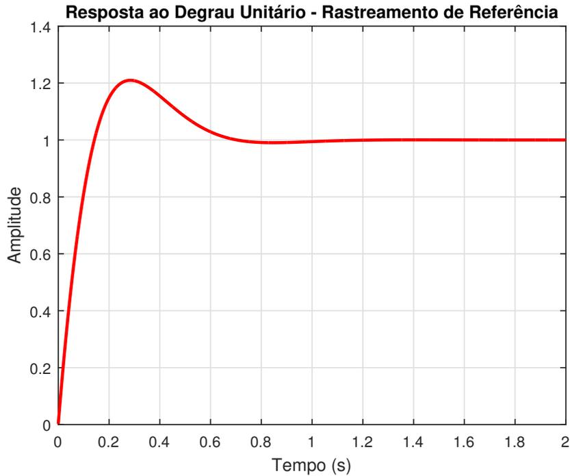
Figura 5.13: Resposta ao degrau unitário do sinal de referência de velocidade angular.
