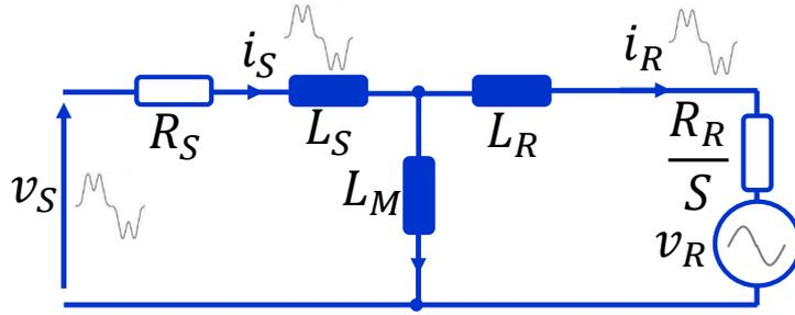
Figura 3.4: Circuito equivalente do DFIG.
