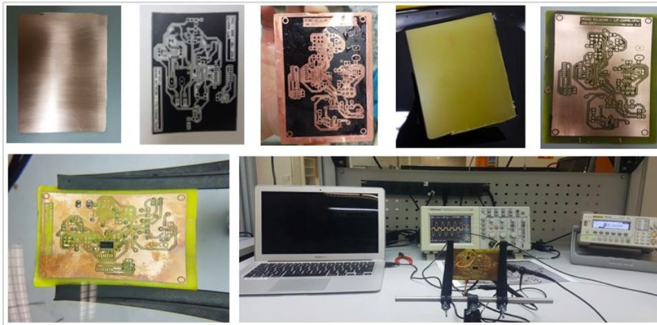
Figura 3.5.2 – Processo de fabricação da PCB.
