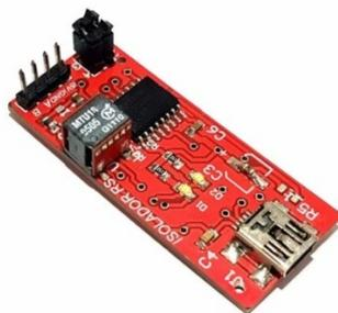
Figura 3.4.4 – PCB da interface isolada RS-485/USB para comunicação com o computador.
