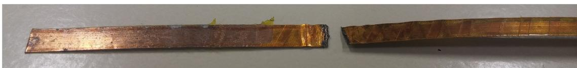
Figura 5.13: Fita HCNK04150 rompida por super aquecimento em ensaios de 200 ms x 500 ms.
