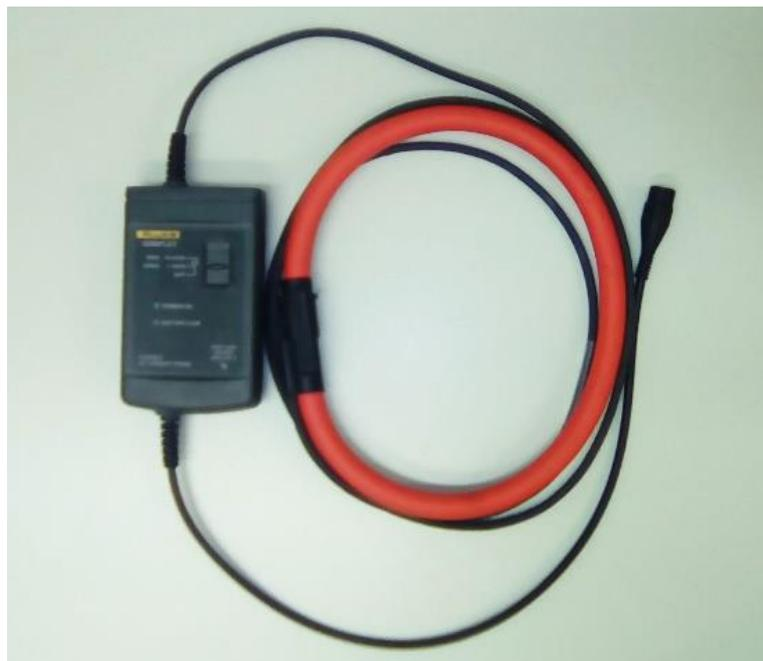
Figura 4.12: Pinça de corrente elétrica Fluke i2000 FLEX
