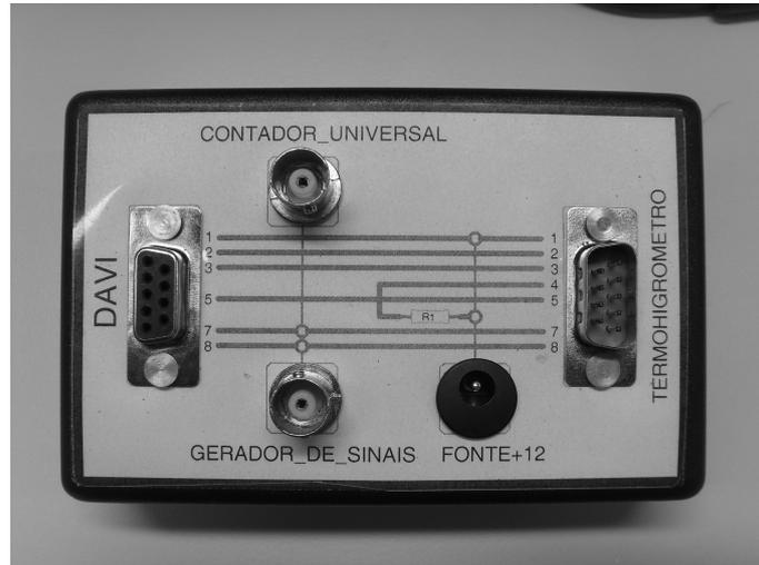
Figura 3.8: Caixa de conexões com diagrama elétrico simplificado das ligações do DAVID aos outros instrumentos.
