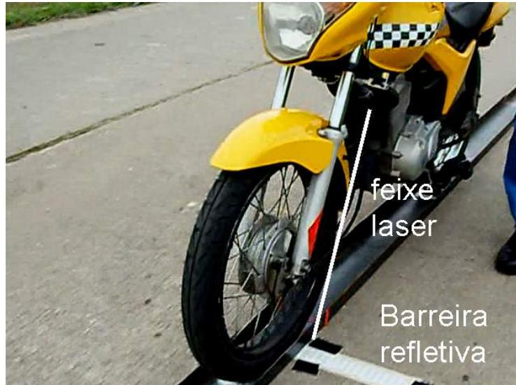
Figura 4.15: Montagem do transdutor no chassi da motocicleta. A barreira com a referência de distância fica na pista.
