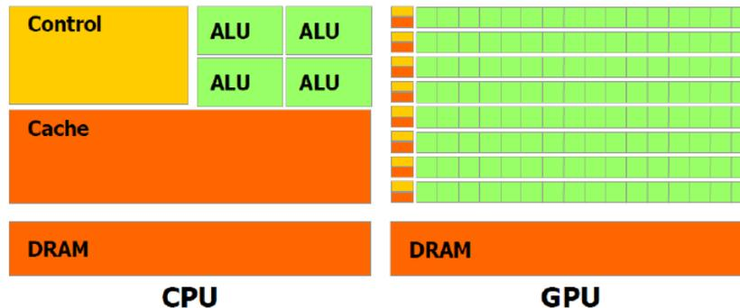
Figura 2-7: Comparação entre as arquiteturas da CPU e GPU [5]
