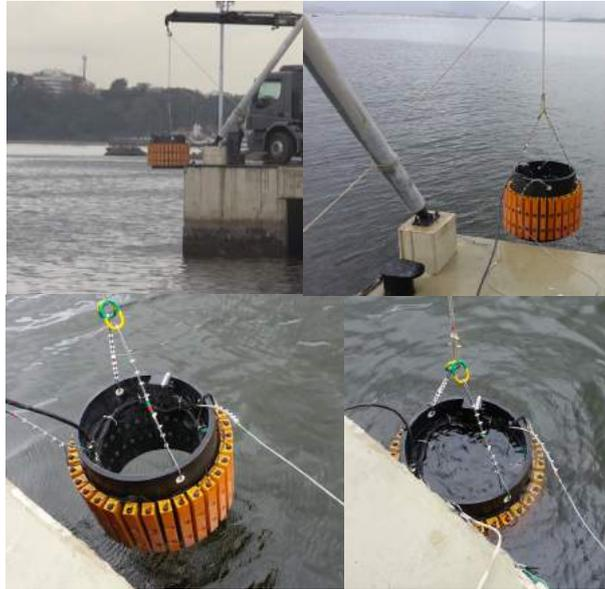
Figura 4.6: Instalação do Arranjo Cilíndrico em um Cais.
