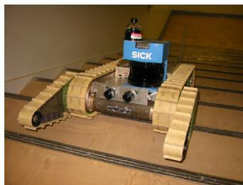
Figura 1.6: Exemplo do robô móvel com esteiras durante a locomoção sobre a escada. Fonte: Helmick et al. (2002)
