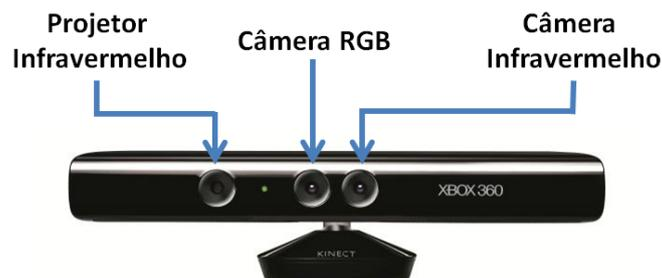
Figura 3.13: Câmeras e projetor que compõem o *Kinect*
