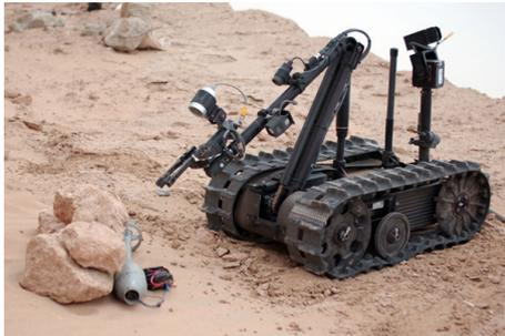
(a) Robô iniciando remoção de artefato explosivo. Fonte: [www.army-technology.com](http://www.army-technology.com)
