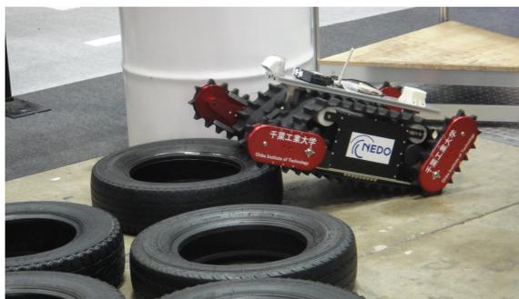
Figura 1.4: Exemplo de robô do tipo EOD utilizando pernas robóticas para superar obstáculos. Fonte: [www.diginfo.tv/v/12-0186-r-en.php](http://www.diginfo.tv/v/12-0186-r-en.php)
