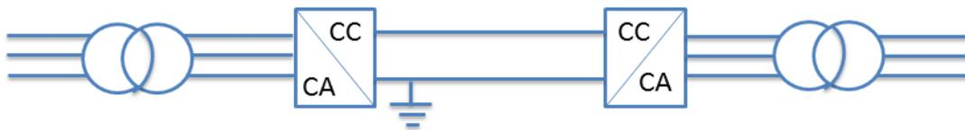
**Figura 20 - Rede MTDC monopolar assimétrica com retorno pelo condutor metálico.**
