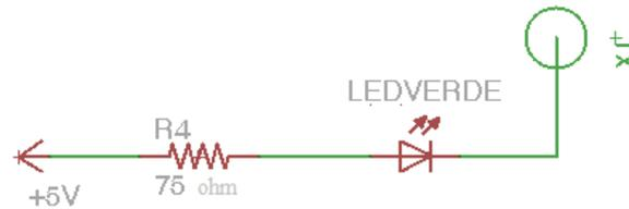
Figura 5.24: Circuito de acionamento do LED.
