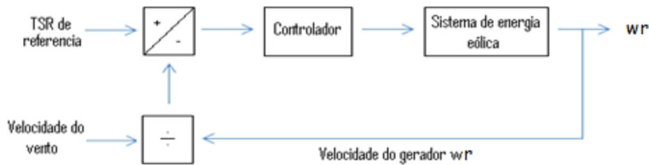
Figura II-12. Controle baseado na relação da velocidade de ponta
