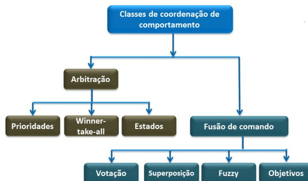
**Figura 3.4:** Mecanismos de seleção das classes de ações. Figura adaptada de (PIRJANIAN, 1999)
