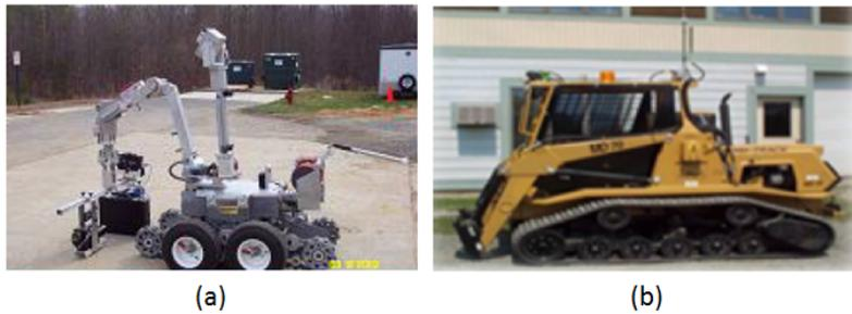
**Figura 1.4:** (a) de uso militar, o robô RONS, é um dispositivo autônomo que atua em áreas de difícil acesso humano, fazendo manipulação de substâncias, resgate de dispositivos e equipamentos. (b) Robô ARTS, semi-autônomo operado em plataforma móvel, utilizado pelas forças armadas dos EUA. Figuras extraídas de
