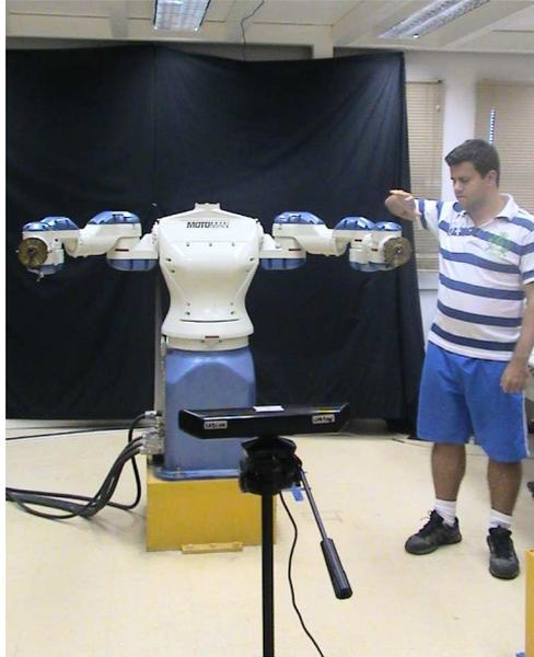
Figura 4.11: Ambiente experimental com o robô manipulador, o dispositivo de interface natural montado em cima de um tripé e o operador.
