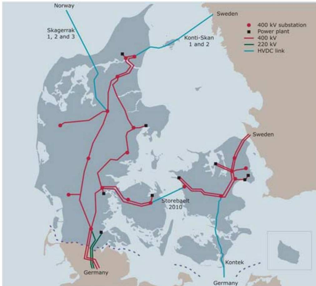
Figura 31 – Situação de DC Multi-Infeed na Dinamarca [15]
