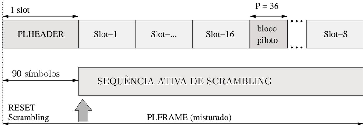
Figura 2.16: PLFRAME após passar pelo módulo de *scrambling*.
