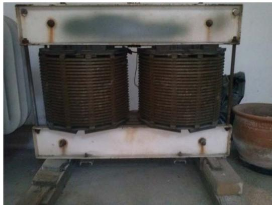
Figura 2.1 – Transformador monofásico.
