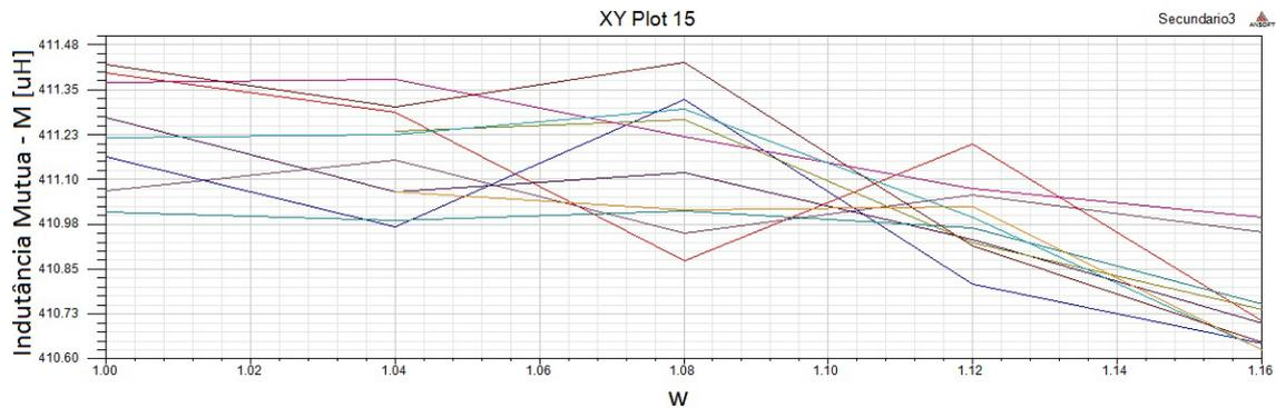
Figura 6.12 – Indutância mútua entre os enrolamentos primário e secundário para diferentes geometrias do secundário.
