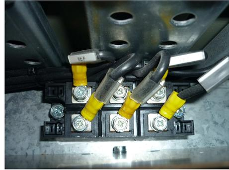
Figura 4.6: Ponte Trif. de Diodo
