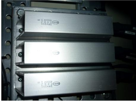
Figura 4.5: Resistores Pré-Carga
