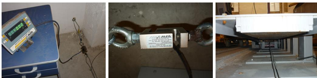
Figura 2.21: Sistema de medição de força longitudinal no EALP 1000/6
