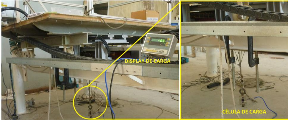
Figura 2.30: Sistema de medição da força de atração desenvolvida pelo motor linear. Primário=257kg, plataforma=98kg, inversor=36kg, guarda-corpo:23.15kg e carga=35.85kg
