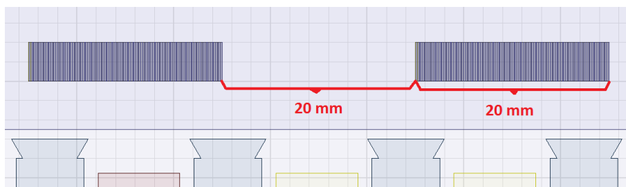
Figura 4.7: Bobina de 20 mm de diâmetro interno e 100 espiras.
