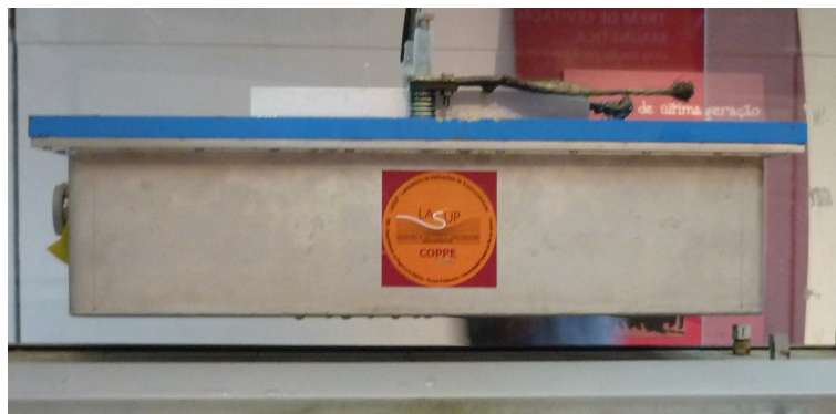
Figura 2.3: Demonstração da levitação supercondutora, o bulk supercondutor se transforma em um ímã de polaridade contrária ao campo a que está submetido.
