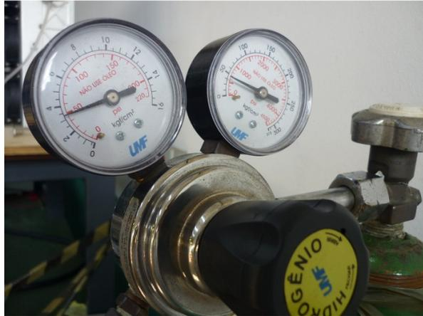
Figura 24: Regulador de pressão do cilindro.
