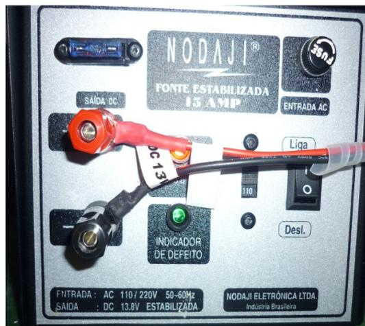
Figura 27: Fonte de alimentação do controlador.
