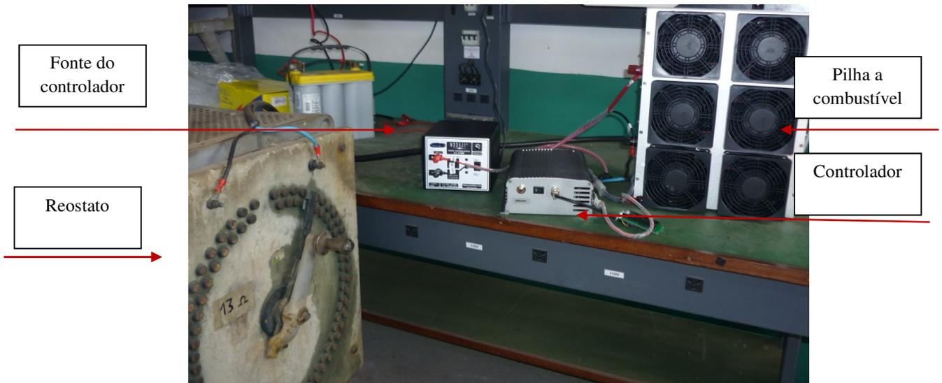
Figura 30: Bancada do sistema de testes.
