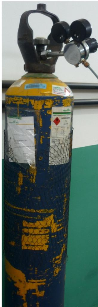
Figura 23: Cilindro de Hidrogênio.
