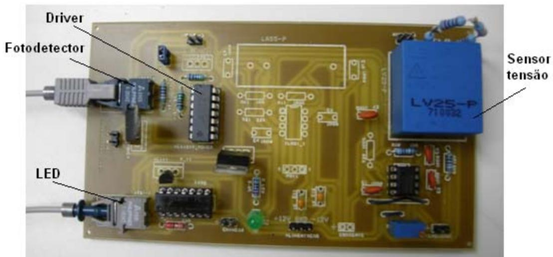
Figura 5.6 – Fotografia da placa do *driver* do conversor *boost* de dois estágios.
