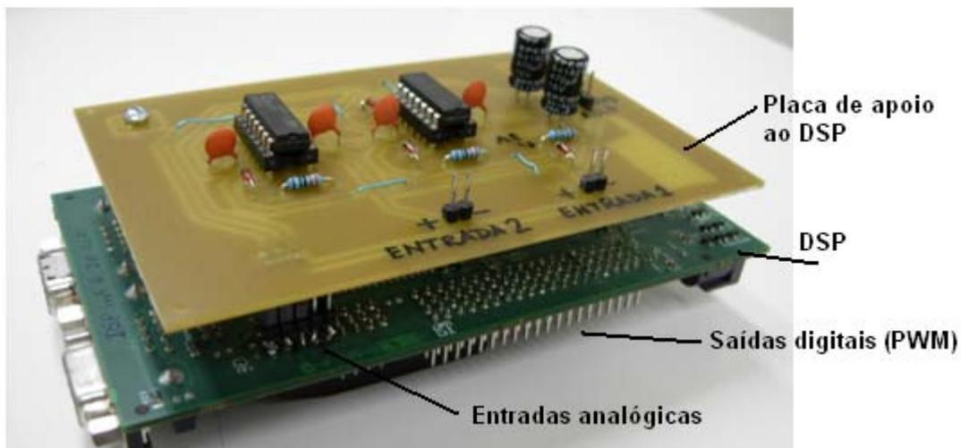
Figura 5.8 – Fotografia da placa de apoio anexada ao DSP.
