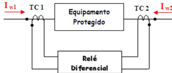
Figura 3.6 – Conexão do Relé Diferencial
