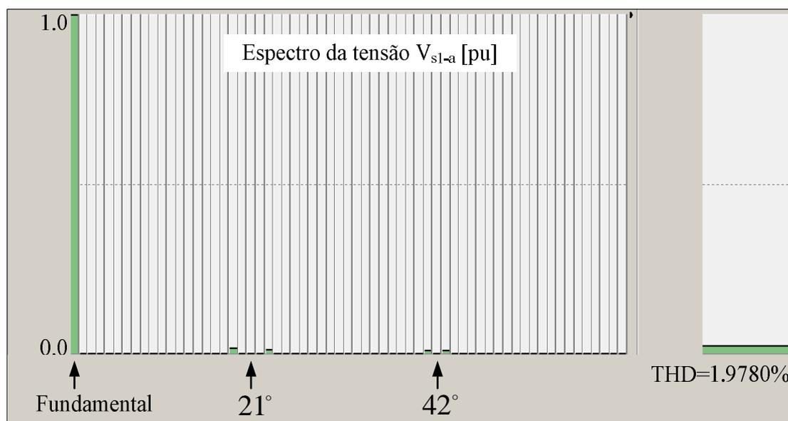
Figura 4.10 – Espectro e DHT da fase “a” da tensão  $V_{s1}$ .
